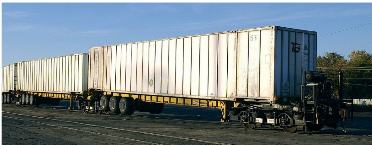
Obrázek 8 Systém Kombirail (Soukup, 2007)
