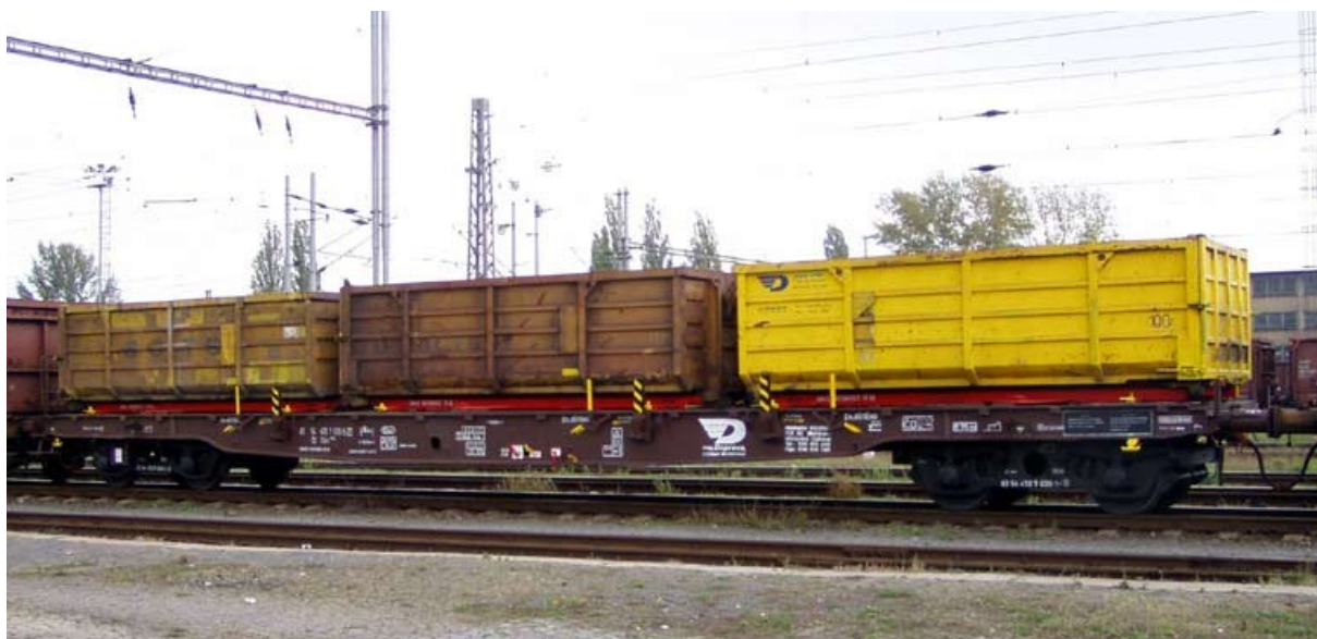
Obrázek 7 Přeprava odvalovacích kontejnerů na železničním voze Slps (Černohorský, 2004)
