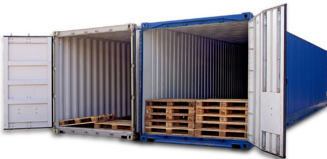
Obrázek 4 Srovnání námořního kontejneru (vlevo) a pozemního kontejneru (vpravo) (CHS Container Group, b. r.)
