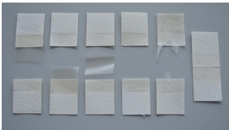
Obr. 84: Různé druhy přetržení spojů u nestárnutých vzorků.
