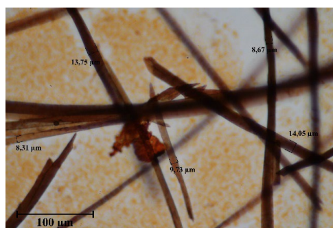
Snímek vláken vzorku AP3DP/11566v Herzbergově činidlo. Fotografováno na optickém mikroskopu Nikon ECLIPSE LV100 při zvětšení na mikroskopu 50x, 100x, 200x a 500x v bílém procházejícím světle.
