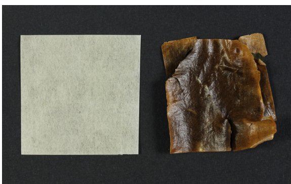
Obr. 82: Fólie Edicol lepená k japonskému papíru škrobem. Stav před stárnutím (vlevo) a po stárnutí (vpravo).
