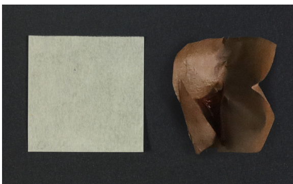
Obr. 80: Fólie Edicol lepená k japonskému papíru roztokem Aquazolu. Stav před stárnutím (vlevo) a po stárnutí (vpravo).
