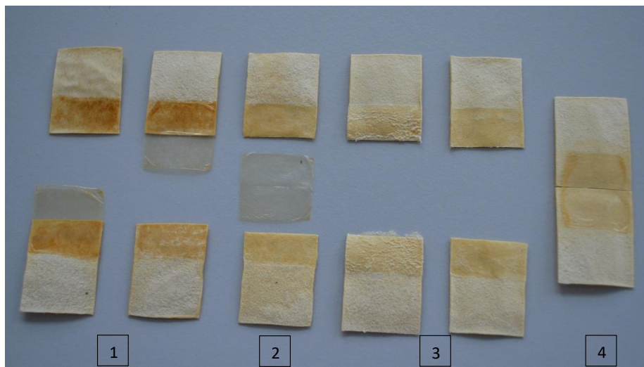
Obr. 2 Různé druhy přetržení spojů u stárnutých vzorků
