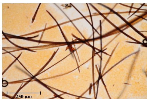
Snímek vláken vzorku AP3DP/11566v Herzbergově činidlo. Fotografováno na optickém mikroskopu Nikon ECLIPSE LV100 při zvětšení na mikroskopu 50x, 100x, 200x a 500x v bílém procházejícím světle.
