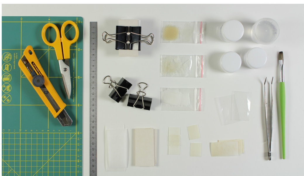
Obr. 42: Pomůcky a materiály používané při výrobě vzorků simulující trhlinu pergamenu.
