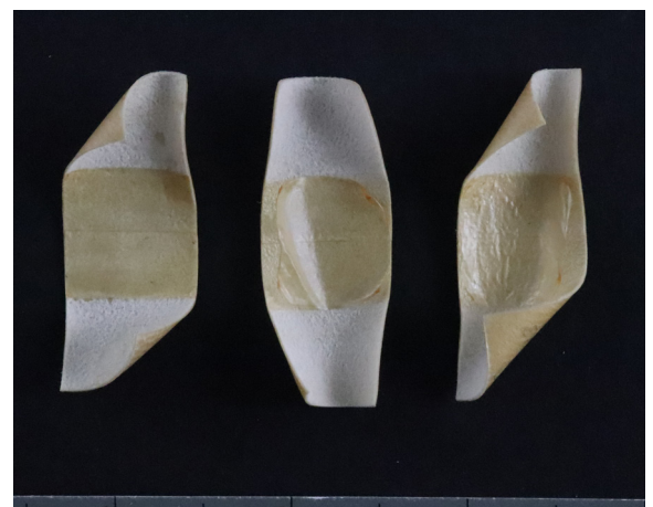
Obr. 70: Průmyslová kolagenní fólie Edicol lepená škrobem. Stav před stárnutím (vlevo) a po stárnutí (vpravo).
