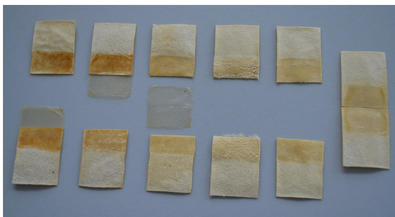
Obr. 85: Různé druhy přetržení spojů u stárnutých vzorků.
