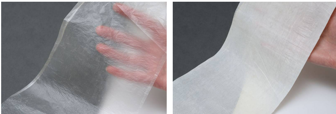
Obr. 37: Přírodní kolagenní blána loužená nečiněná (vlevo) a činěná kamencem (vpravo). Franz Hoffmann-Feinleder. Online, dostupné z: https://www.feinleder-hoffmann.com/en/articles/article-range/natural-skin-parchment/goldbeater-skin.html [cit. 2024-6-23].
