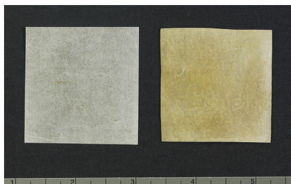
Obr. 75: Japonský papír lepený k japonskému papíru želatinou. Stav před stárnutím (vlevo) a po stárnutí (vpravo).
