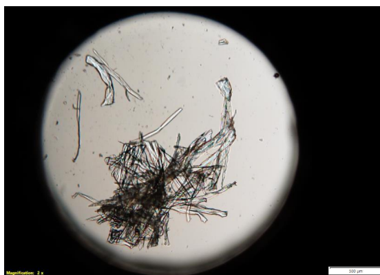
Obr. 4 Vzorek v měřicí cele FP82, před měřením teploty smrštění
