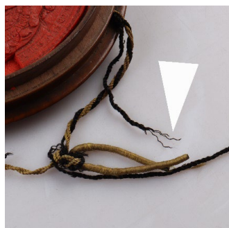
Místo odběru (fotografie Anna Pátková) a makrosnímek vzorku AP3DP/11566. Fotografováno na stereomikroskopu SMZ 800, bílé dopadající světlo, zvětšení na mikroskopu 30x.
