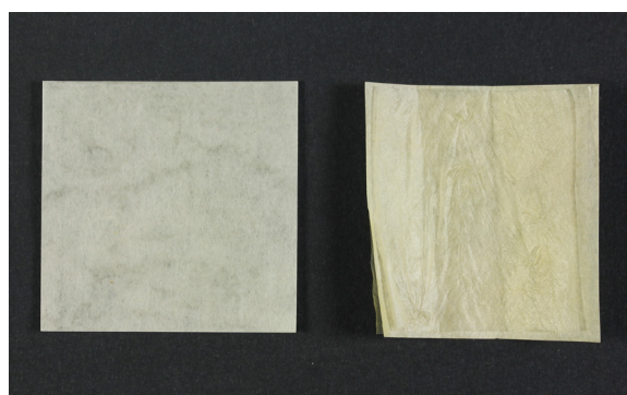
Obr. 77: Přírodní kolagenní blána lepená k japonskému papíru roztokem Klucelu H. Stav před stárnutím (vlevo) a po stárnutí (vpravo).
