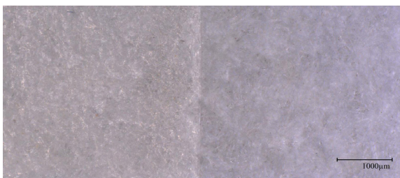
Obr. 71: Průmyslová kolagenní fólie Edicol lepená želatínou. Stav před stárnutím (vlevo) a po stárnutí (vpravo).
