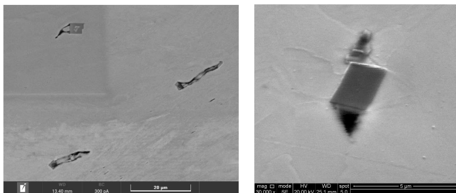
Obrázek 2.8 Ukázky iniciace mikrotrhlin na karbidech
