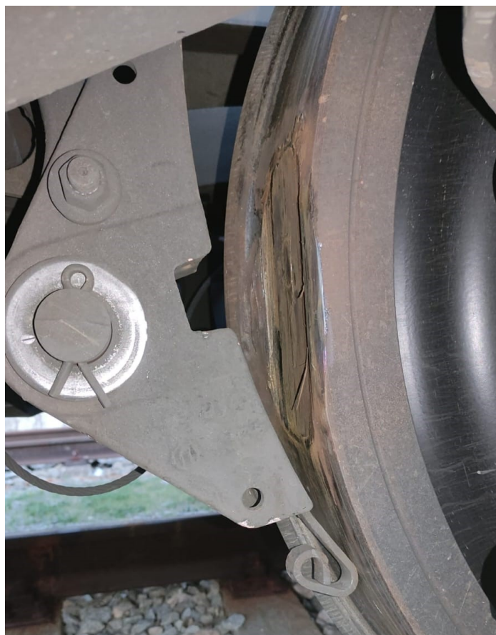
Obr. 4: Příklad extrémně poškozené jízdní plochy kola následkem smýkání zablokovaného dvojkolí po kolejnici. Jedná se o nákladní vůz vybavený špalíkovou brzdou. Autor fotografie: Daniel Forejtár
