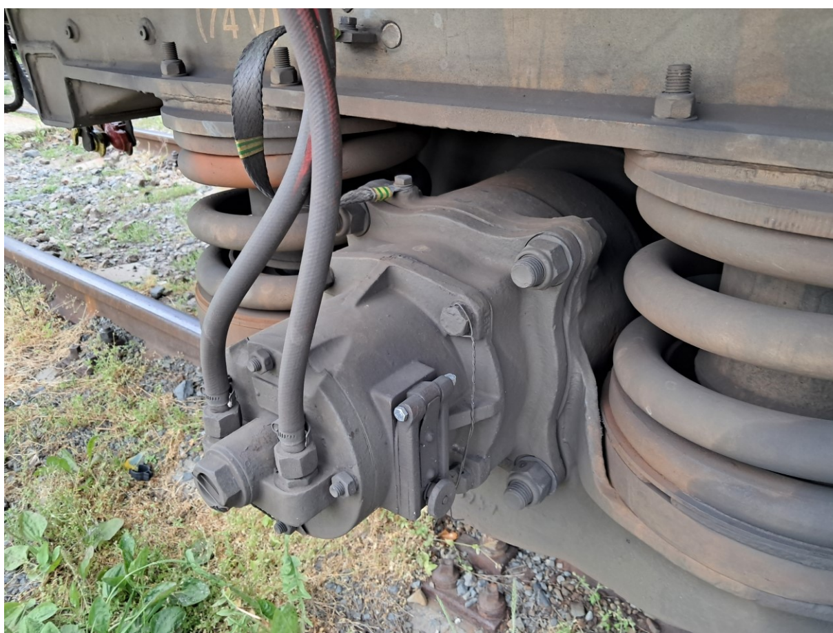
Obr. 15: Odstředivý regulátor DAKO-K uchycený na ložiskové skříni podvozku Görlitz V vozu řady B 249 . Fotografie: autor práce.
