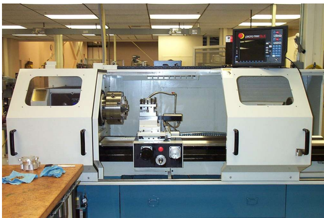
Obrázek 2 - Moderní CNC soustruh [3]
