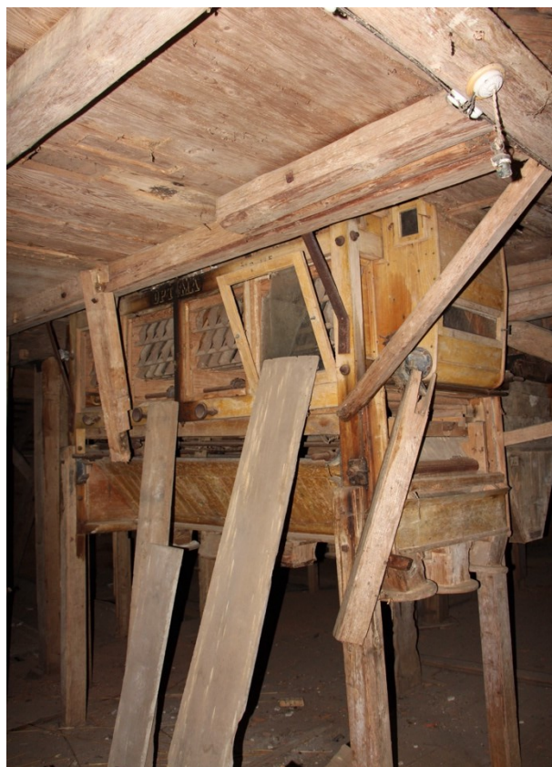
Obr. 119 a 120: (vlevo) Žebříkové schody s trémovými schodnicemi a deskovými stupni pokrytými lištovaným bedněním; (vpravo) dva hranolové vysévače v druhém patře
