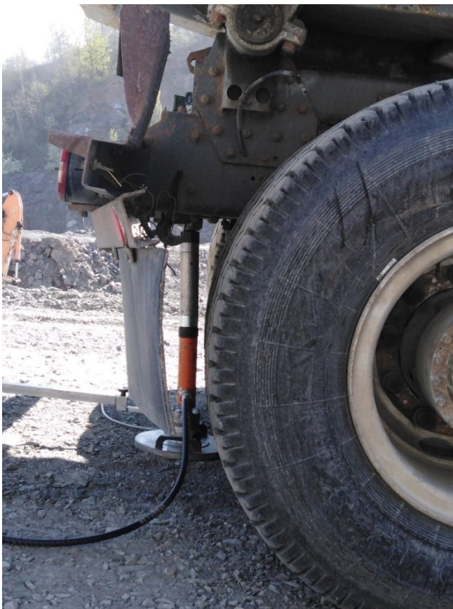
Obrázek č. 19 – Boční pohled na statickou zatěžovací zkoušku
