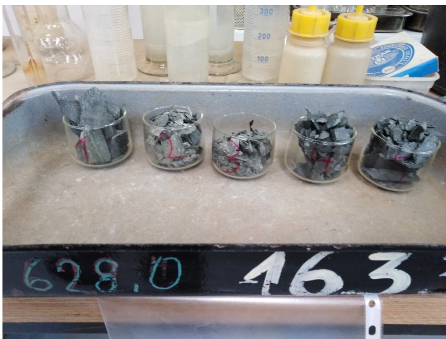
Obrázek č. 7 – Připravené vzorky pro určení vlhkosti
