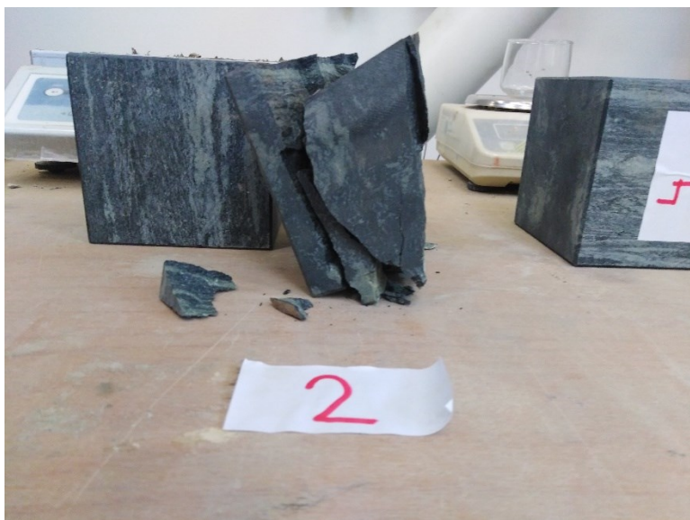
Obrázek č. 3 – Porušení tělesa č. 2
