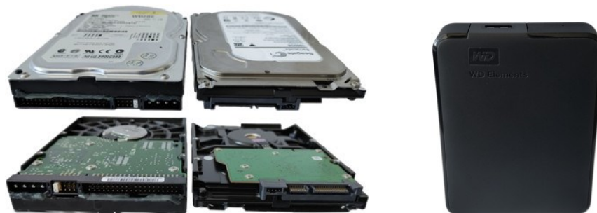
Obrázek 4 – Interní 3,5" HDD (vlevo rozhraní IDE, vpravo rozhraní SATA) vlevo a externí 2,5" HDD (rozhraní USB 3.0 Micro-B) vpravo
