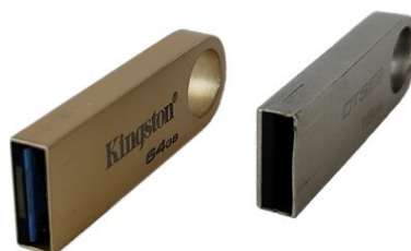
Obrázek 14 – USB flash disk (64 GB s modře označeným rozhraním USB 3.0 a 16 GB s USB 2.0)
