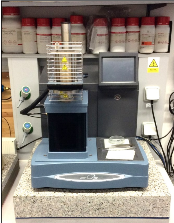
Obr. 27 Přístroj Q400 TMA pro měření termomechanické analýzy.
