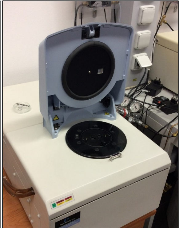
Obr. 28 Přístroj DCS Diamond pro měření kalorimetrické analýzy.
