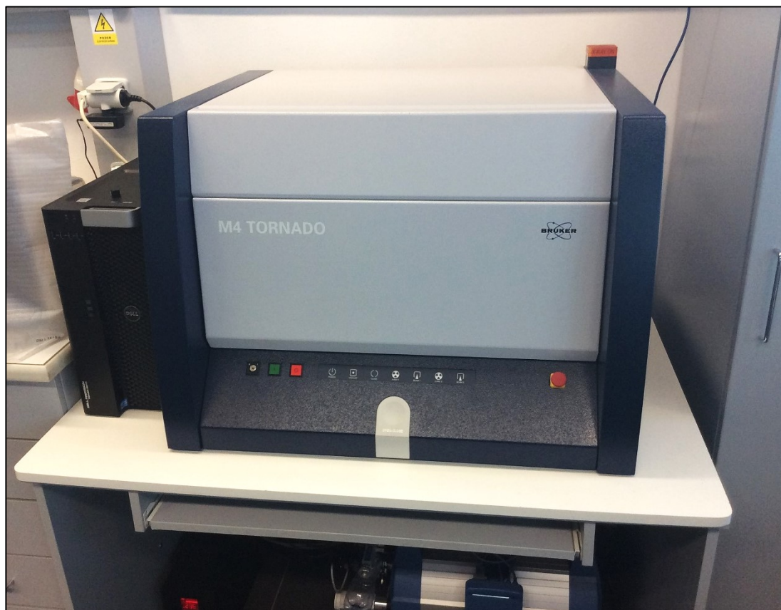
Obr. 26 Spektrometr \mu -XRF M4 Tornado (Bruker) pro měření rentgenové fluorescence.
