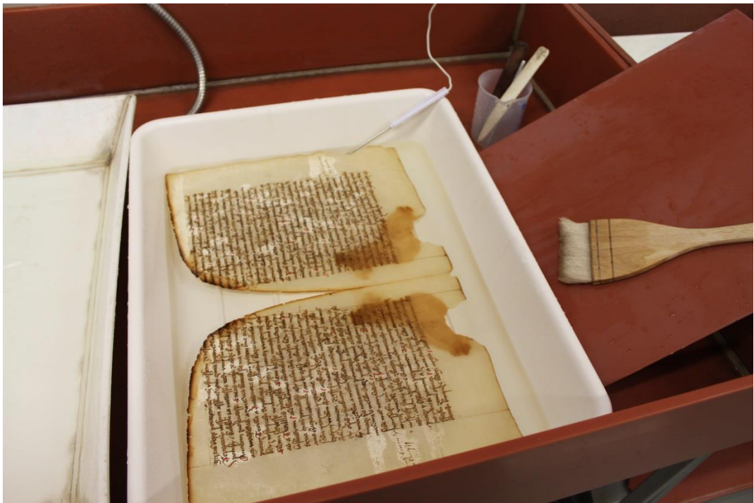
obr. 62 Koupání listů v teplé vodní lázni.
