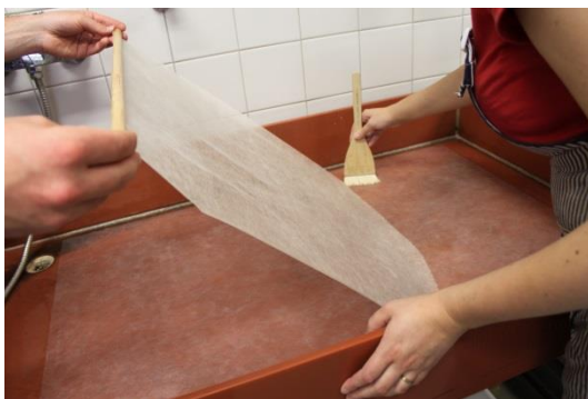
obr. 5 Pokládání japonského papíru na Hollytex
