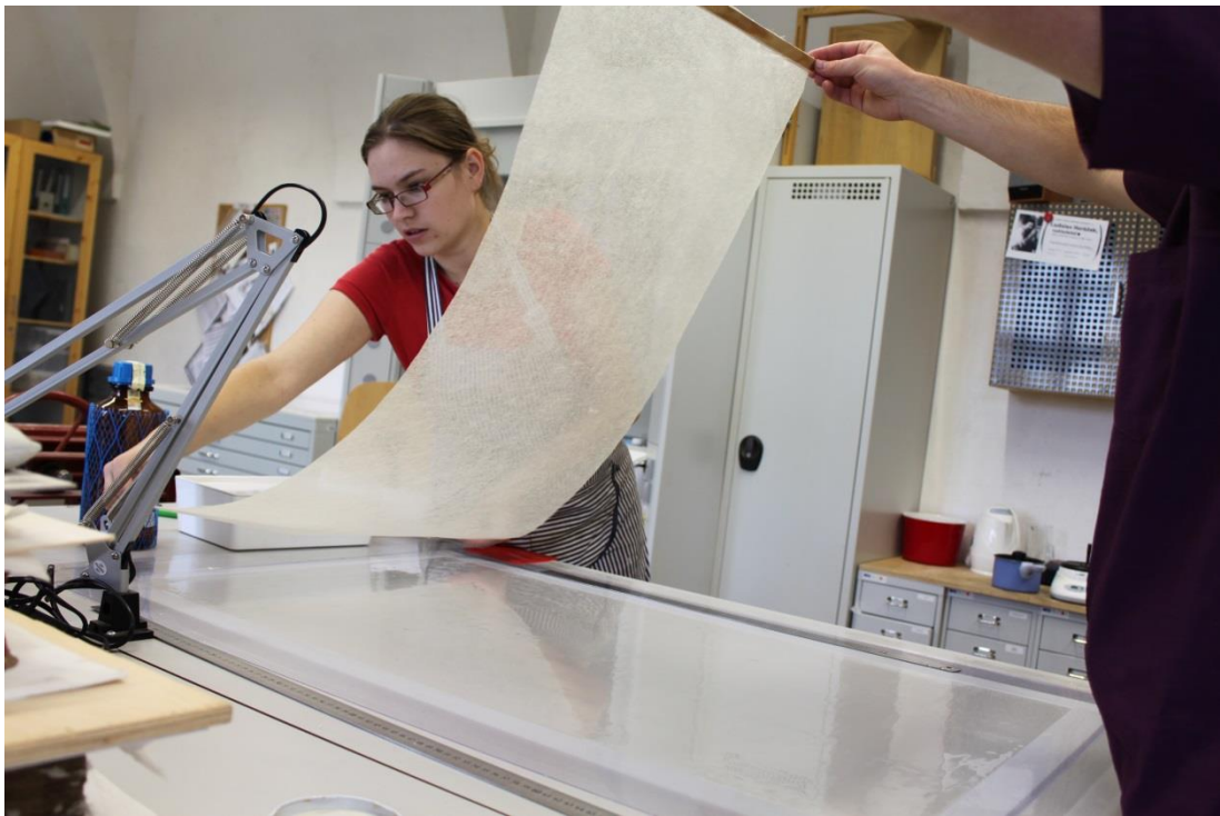
obr. 70 Výroba laminační folie – pokládání japonského papíru na vrstvu Klucelu
