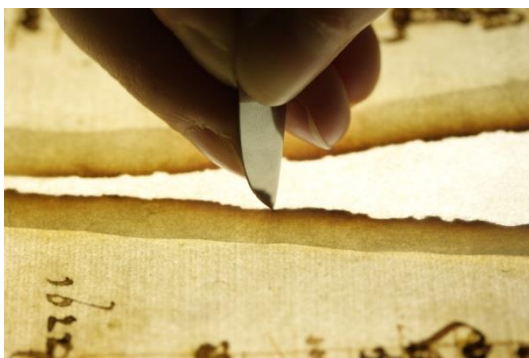
obr. 27 Nařezávání japonského papíru podél ztráty. obr. 28 Vyrhnutí přesahu japonského papíru.
