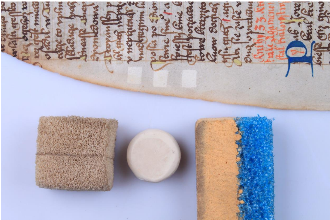
obr. 58 Sondáž mechanického čištění - zleva - Wallmaster, Milan, Wishab
