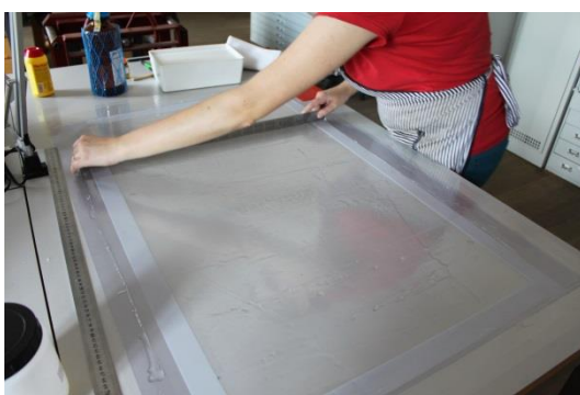
obr. 9 Zarovnání plochy lepidla do stejné síly.
