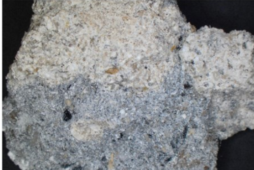
Obr. 4 Makrosnímek probarvené vrstvy intonaca colorata (vzorek SSP 3). Autor: J. Válek.
