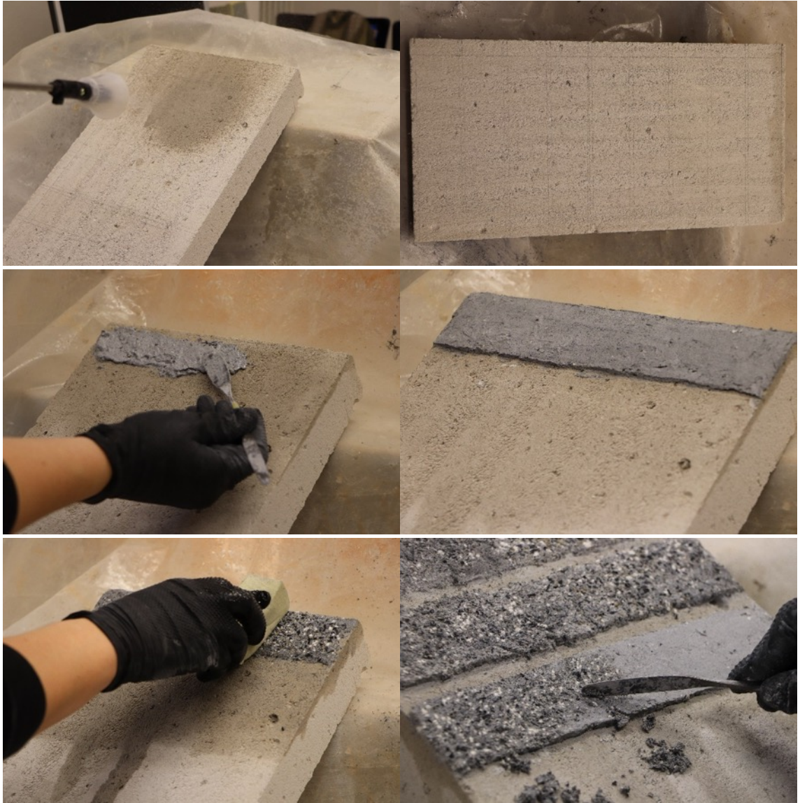
Obr. 14 Postup nanášení vzorových malt
