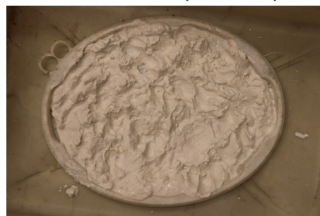
Obr. 6 Čerstvě vyrobená vápenná kaše.
