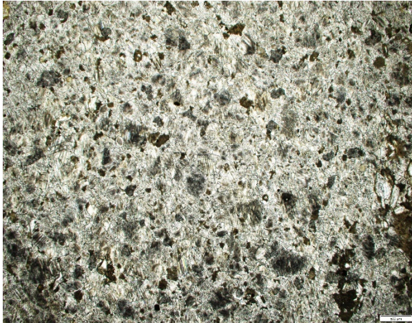
Mikrofotografie struktury vzorku s převažujícími krystaly kalcitu, pozorováno v procházejícím světle. Měřítka: 0,5 mm.
