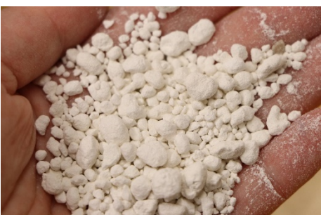
Obr. 7 Kulaté pojivové částice před použitím do směsí.
