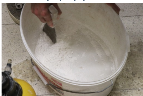
Obr. 3 Míchání hydrátu špachtlí.
