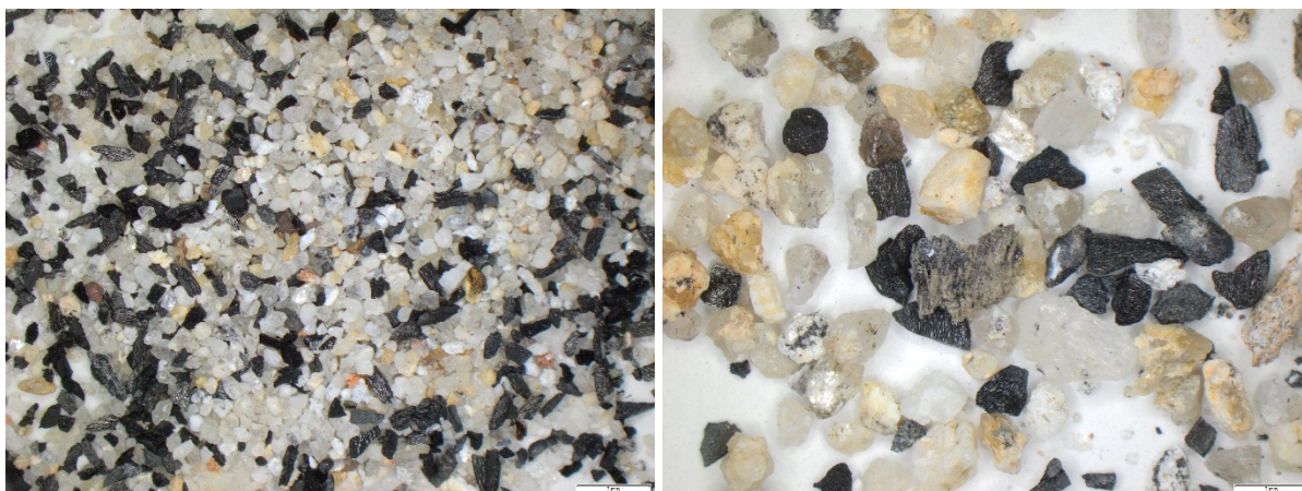
Mikrofotografie jednotlivých frakcí písku: frakce 0,25-0,5 mm (vlevo) a frakce 1-2 mm (vpravo).
