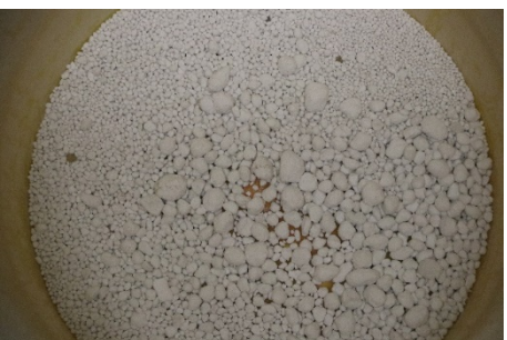
Obr. 5 Vzniklé zaoblené pojivové částice.
