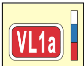
Obrázek 23 Označovací štítek a nátěr vloženého návěstidla
