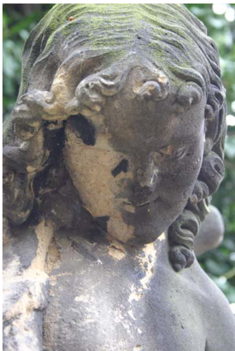
Obr. 3. Detail poškození tváře anděla Vlivem degradace kamene pod sádrovcovou krustou
