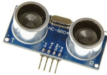
Obrázek 7 Ultrazvukový senzor HC-SR04(27)
