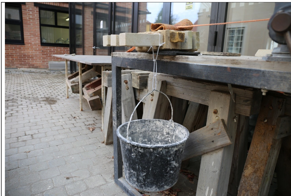
Obr. 2 Zkoušky pevnosti spoje ošetřeného Polaroidem-B72
