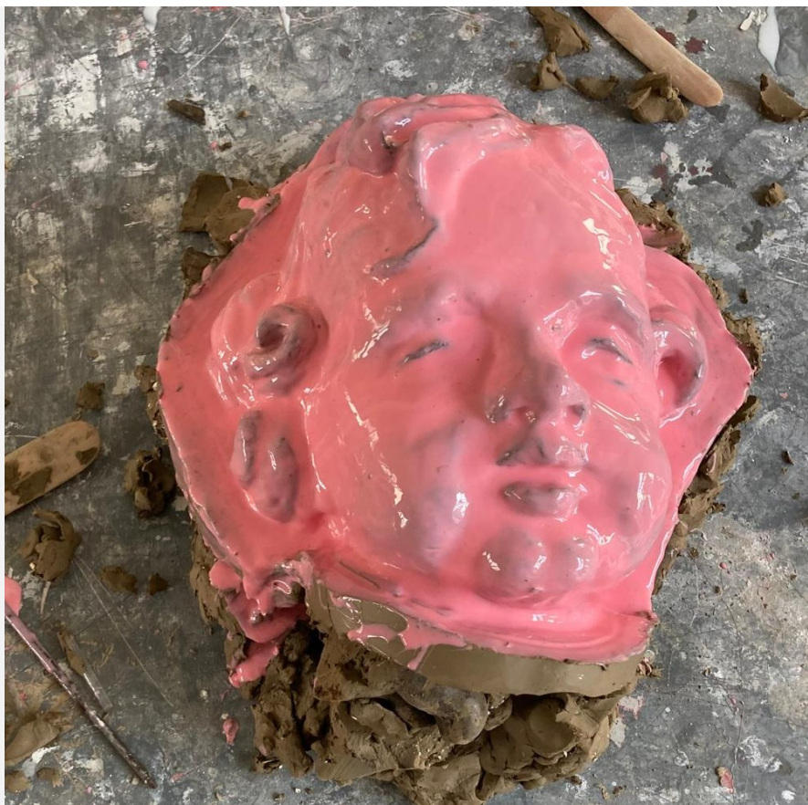
Obr. 30 Průběh výroby silikonové formy na hlavu andílka
