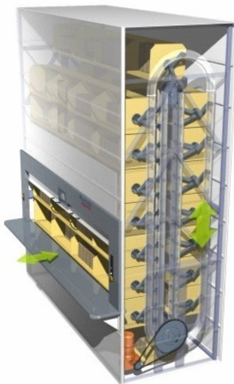
Obrázek 3: Princip vertikálního karuselového zásobníku (Industrial-Storage-Carousel.jpg, 2024)
