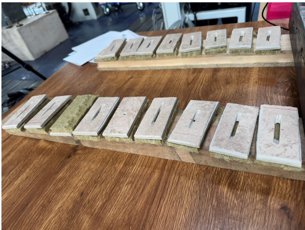
Obrázek 32 Keramické destičky s nalepenou vrstvou minerální vaty
