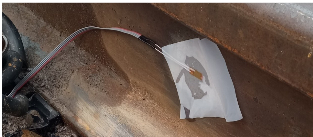
Obrázek 7 Nalepený tenzometr (ještě s teflonovou přikrývkou) [11, s. 13]
