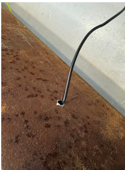
Obrázek 37 Instalace sondy DS18B20 do připraveného otvoru na patě Ek
