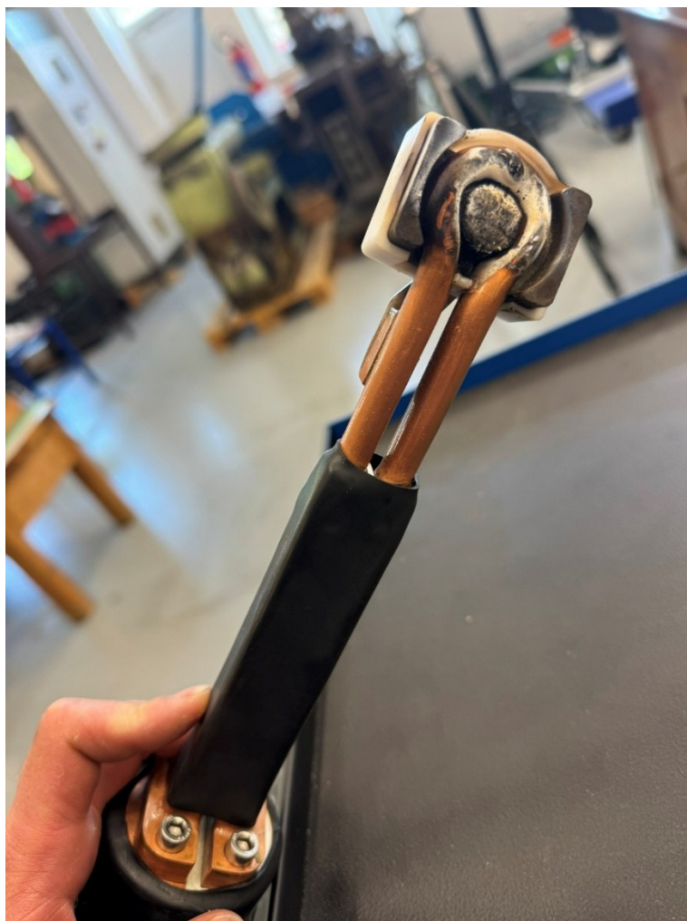
Obrázek 20 Indukční smyčka pro lokální ohřev
