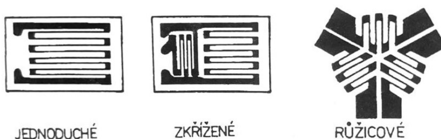
Obrázek 2 Konstrukce foliových čidel [9, s.12]
