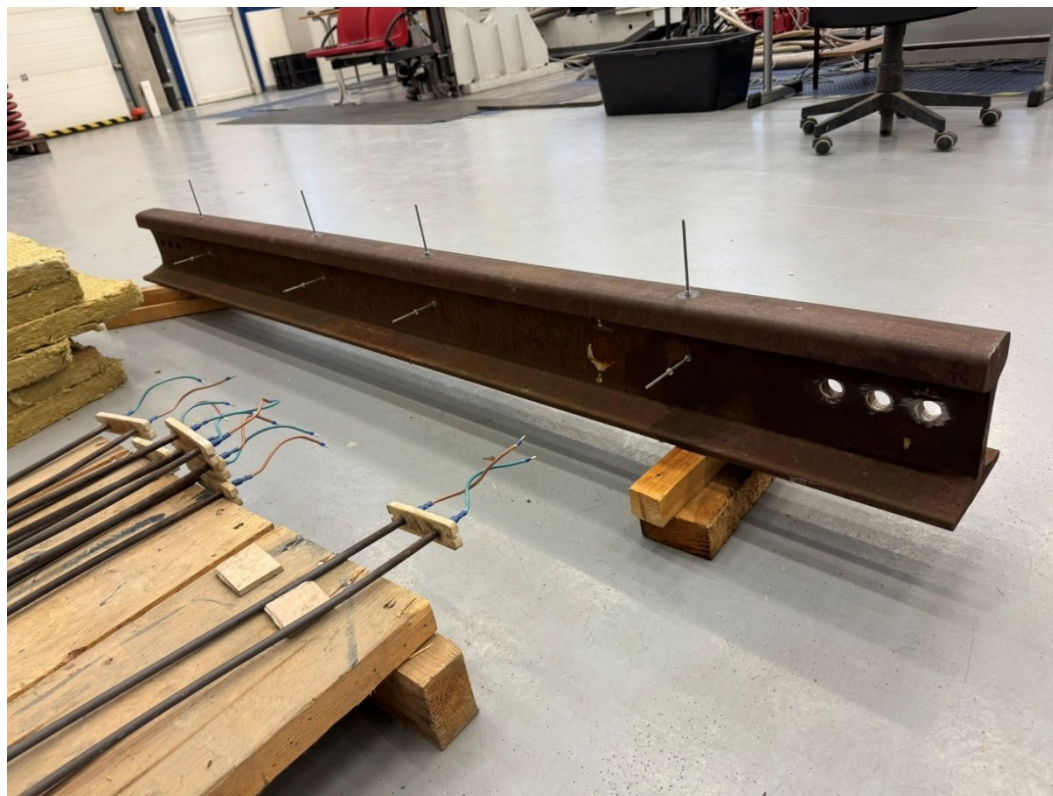
Obrázek 27 Osazené závitové tyče elektricky izolovaného uchycení topných těles
