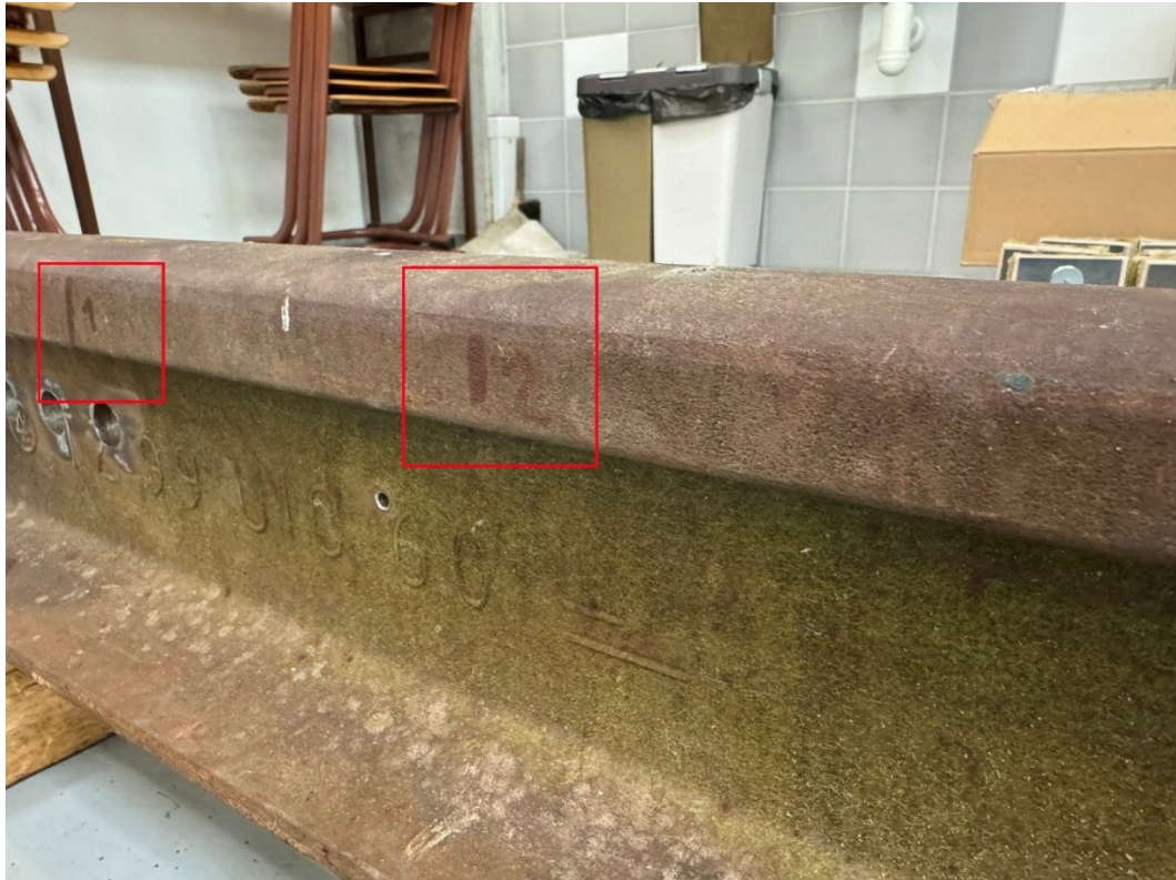
Obrázek 14 Fyzické značení měřicích profilů experimentální kolejnice
