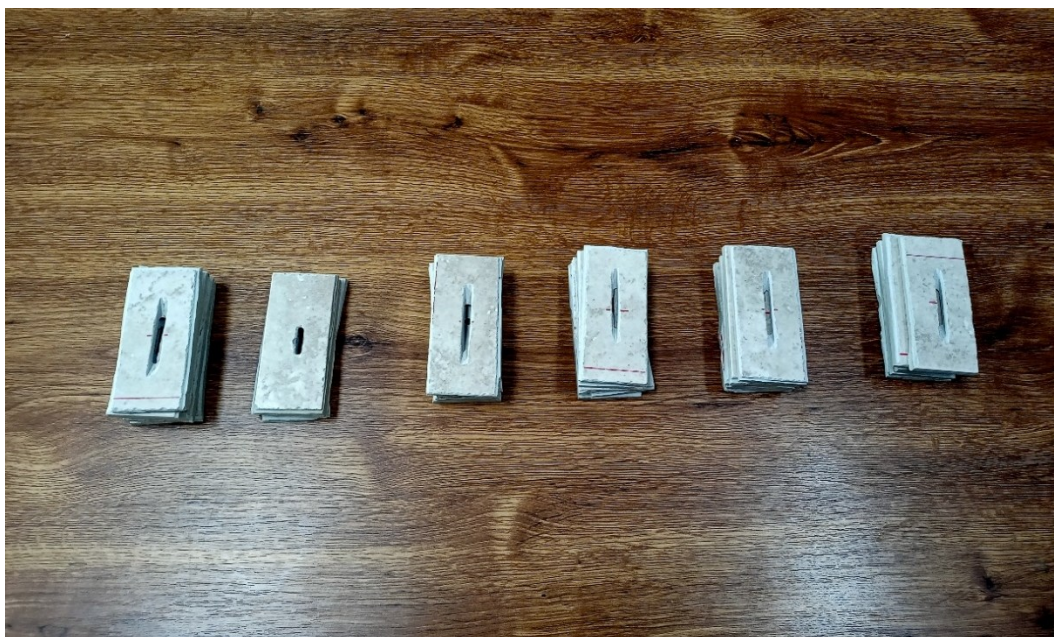
Obrázek 29 Keramické destičky s vyřezanou drážkou pro umístění závitové tyče
