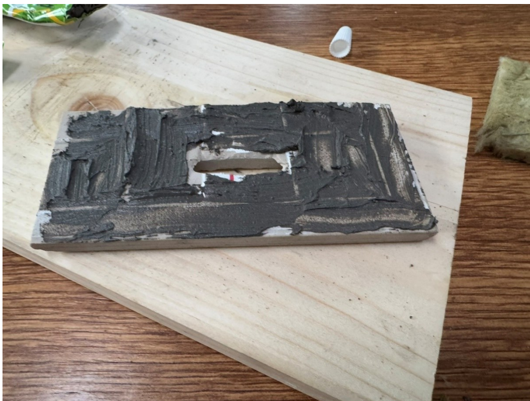
Obrázek 31 Nanesení žáruvzdorného lepidla Hermetic 35 Professional na vnitřní stranu keramické destičky
