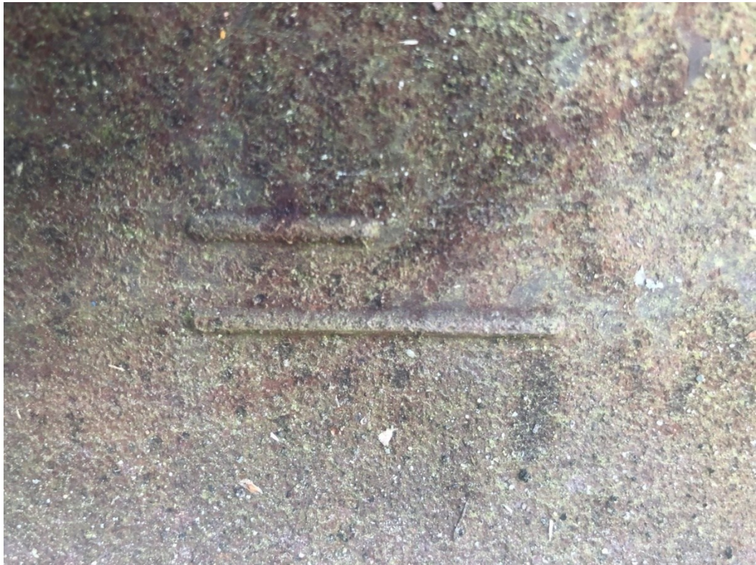
Obrázek 11 Označení třídy kolejnicové oceli na experimentální kolejnici
