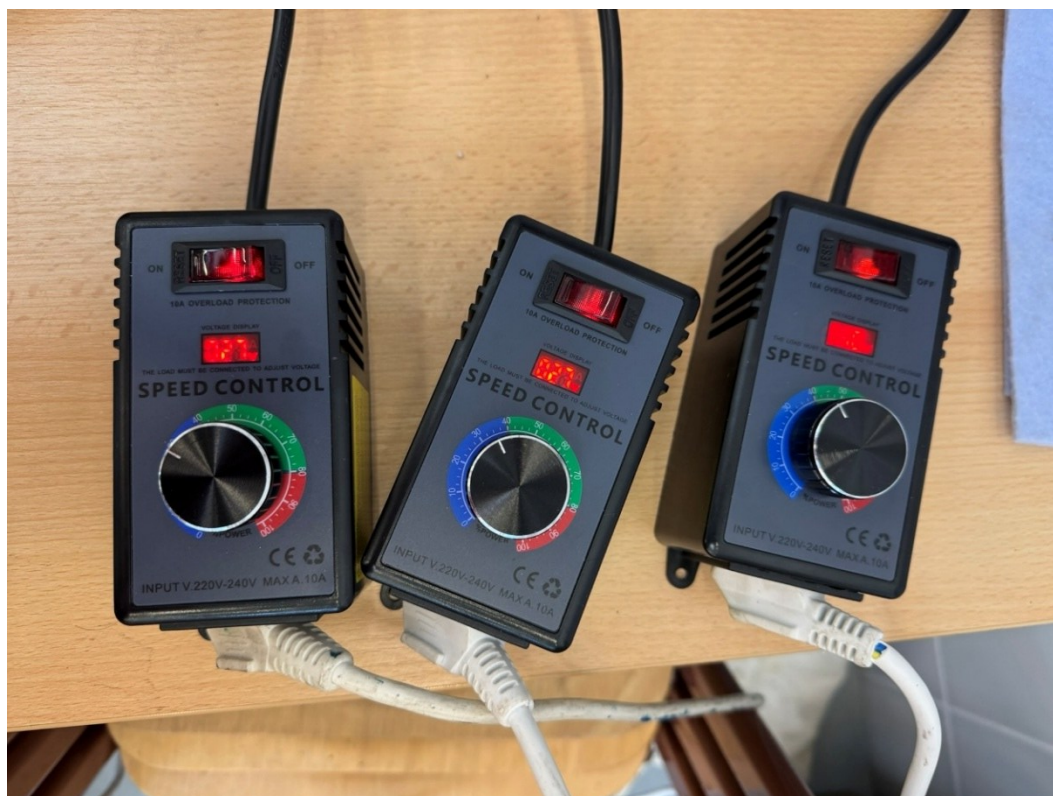
Obrázek 25 Trojice regulátorů napětí při zkoušce ohřevu
