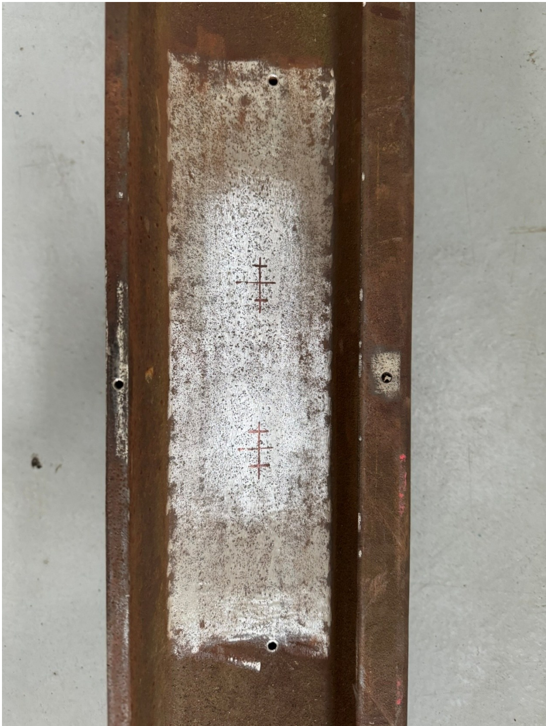
Obrázek 47 Příprava povrchu Ek pro osazení tenzometrů – stojina kolejnice
