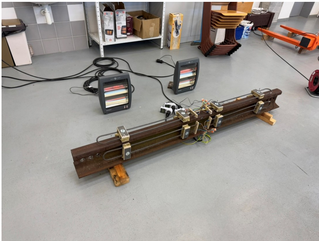
Obrázek 21 Dvojice infrazářičů při zkoušce ohřevu Ek
