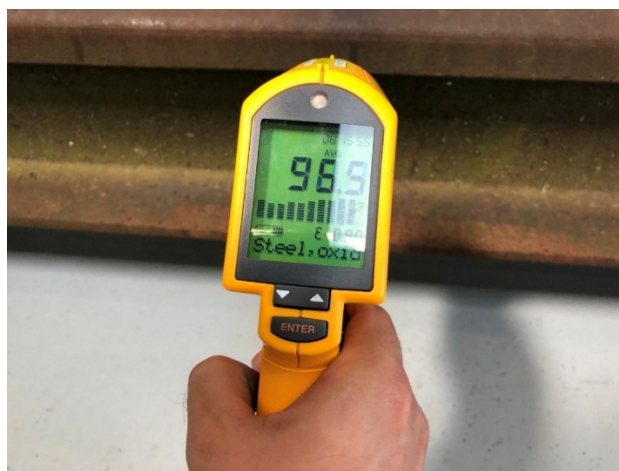
Obrázek 35 Bezkontaktní laserový teploměr Fluke 574 při měření
