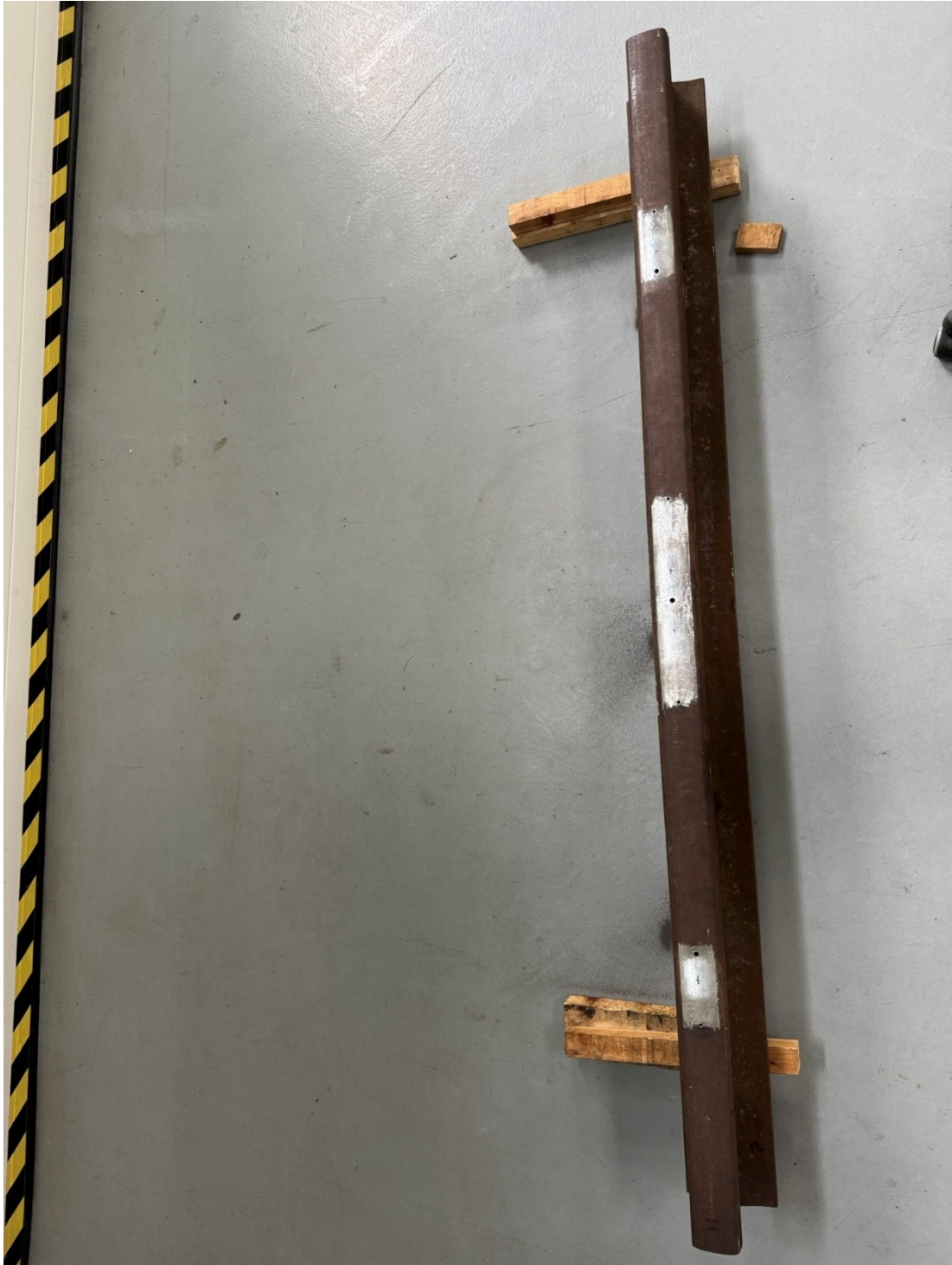
Obrázek 45 Příprava povrchu Ek pro osazení tenzometrů
