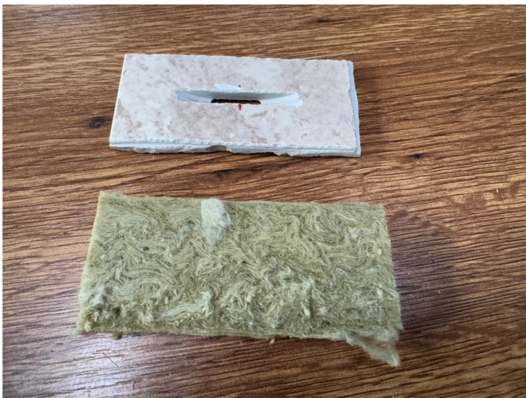
Obrázek 30 Keramická destička a vrstva minerální vaty před lepením
