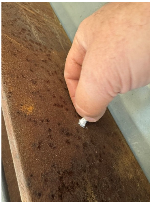
Obrázek 38 Zajištění teplotní sondy aplikací zátky z papírové buničiny
