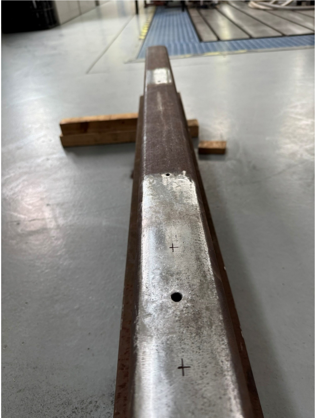
Obrázek 46 Příprava povrchu Ek pro osazení tenzometrů – hlava kolejnice
