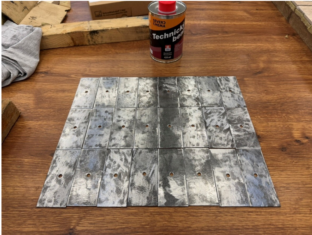
Obrázek 33 Odvrtané, obroušené a odmaštěné plechy připravené na lepení
