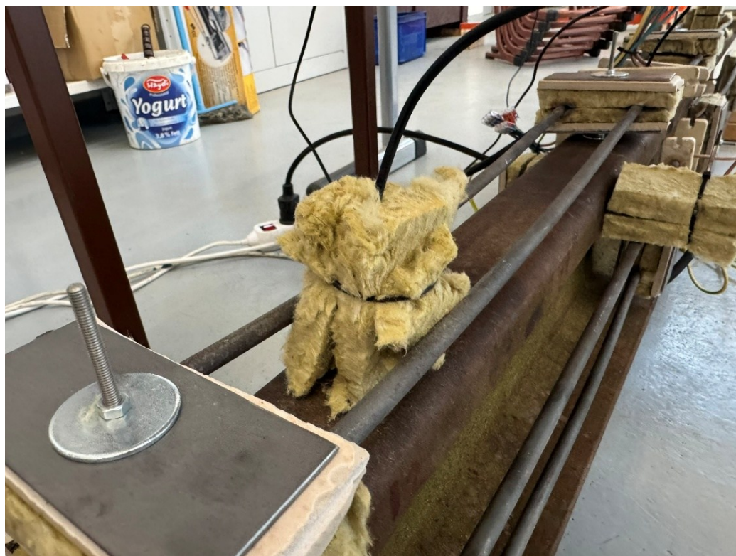
Obrázek 39 Tepelná ochrana přívodních kabelů teplotních sond z minerální vaty
