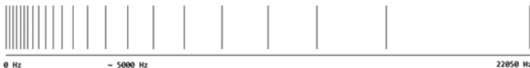
Obrázek 8 - Rozdělení pásma na subpásma měřítek - dlouhý blok 44100 Hz (zdroj: [9])
