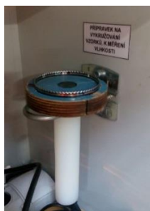
Obrázek 13 Přípravek na vykružování vzorků pro měření absolutní vlhkosti
