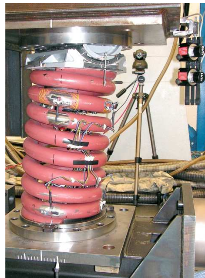
Obr. 52 Celkový pohled na sestavu pružina–podložka při natočené podložce.
