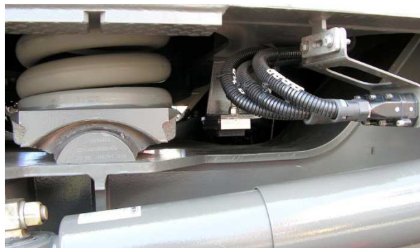
Obr. 39 Uložení sekundár. pružin lokomotivy SIEMENS.
