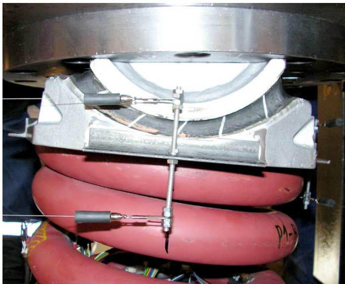
Obr. 51 Testovaná pryžokovová podložka s lankovými snímači pro měření smykové a úhlové deformace podložky.
