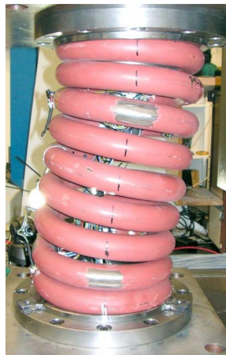
Obr. 44 Flexi-coil pružina sekundárního vypružení lokomotivy ŠKODA při měření příčné tuhosti a mechanického napětí v pružině.
