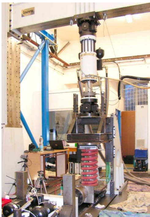
Obr. 43 Zkušební stav INOVA pro testování charakteristik prvků vypružení kolejových vozidel v těžkých laboratořích DFJP v Pardubicích.
