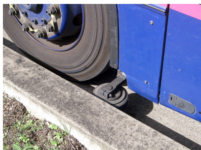
obr. 2: detail bočního vedení obrubníkem vozovky
