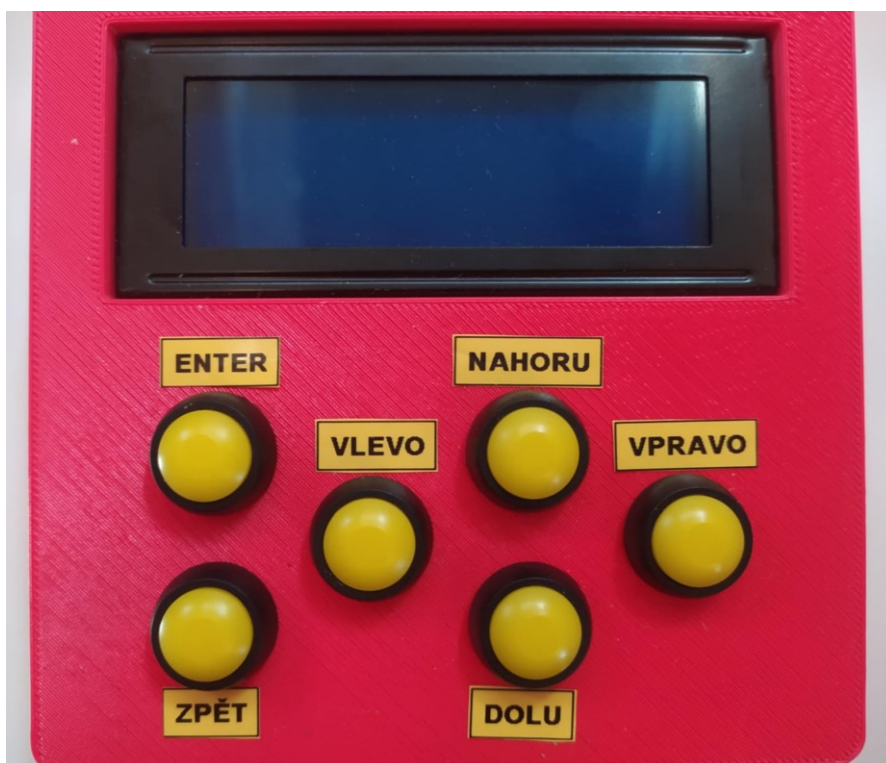
Obr. 85 – Ovládání jednotky pro měření rychlosti a zrychlení
