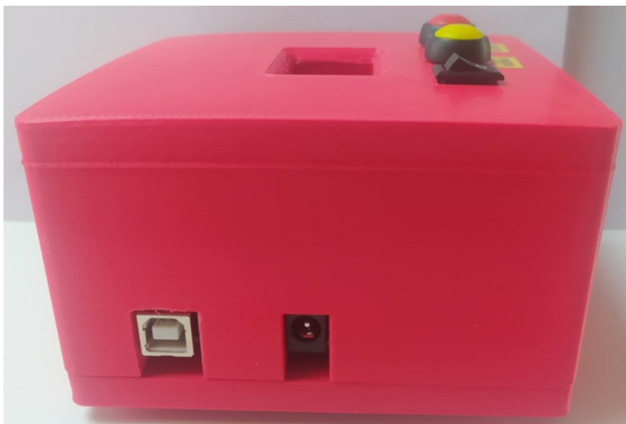
Obr. 77 – Bok jednotky pro příjem naměřených dat – souosí a USB konektor
