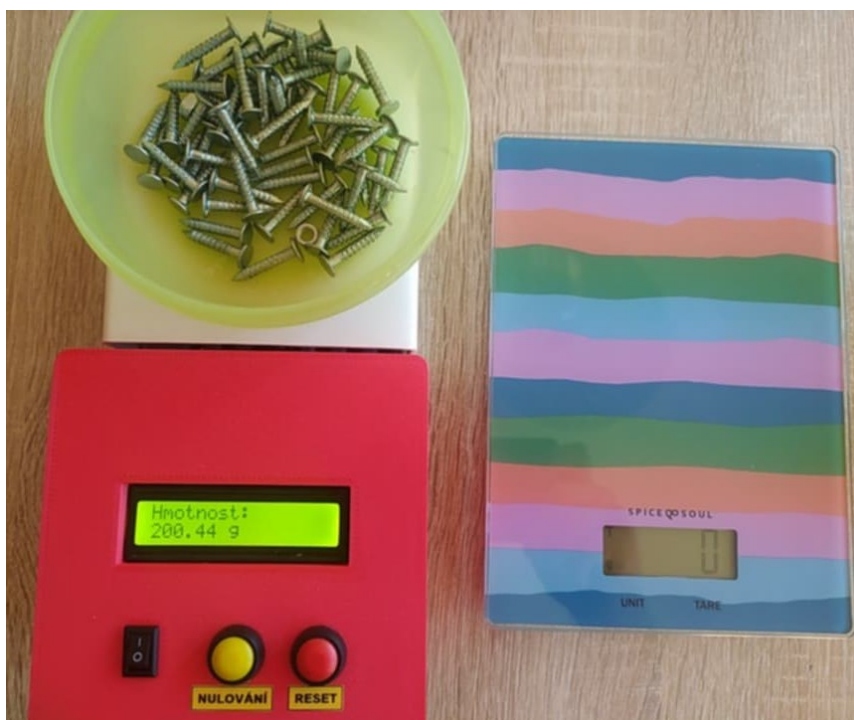
Obr. 143 – Testování jednotky pro měření hmotnosti – závaží na jednotce
