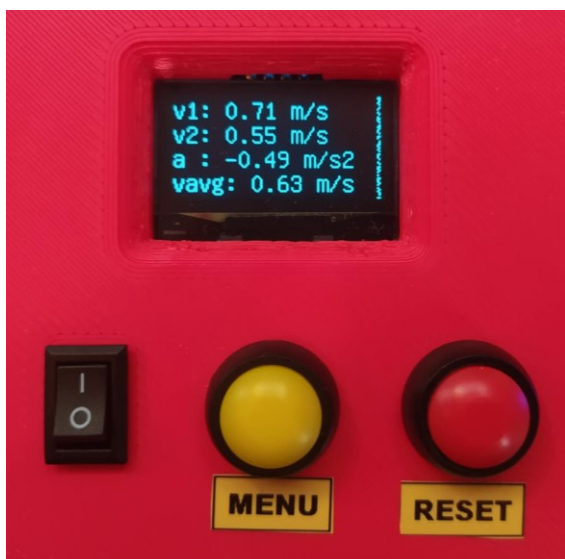
Obr. 74 – Zobrazení naměřených hodnot rychlosti a zrychlení na displeji jednotky pro příjem naměřených dat
