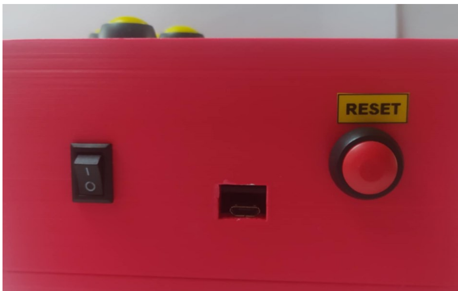
Obr. 86 – Bok jednotky pro měření rychlosti a zrychlení – RESET, USB port a vypínač
