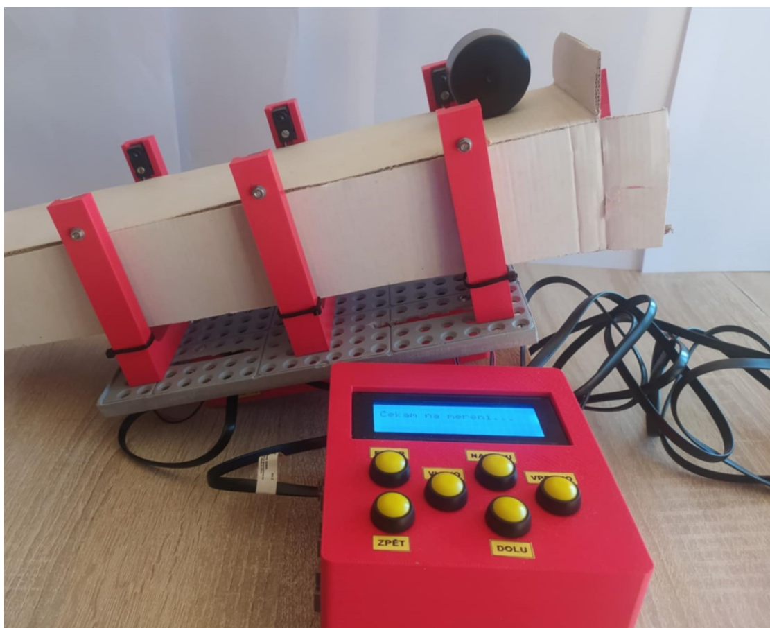
Obr. 140 – Testování jednotky pro měření rychlosti a zrychlení
