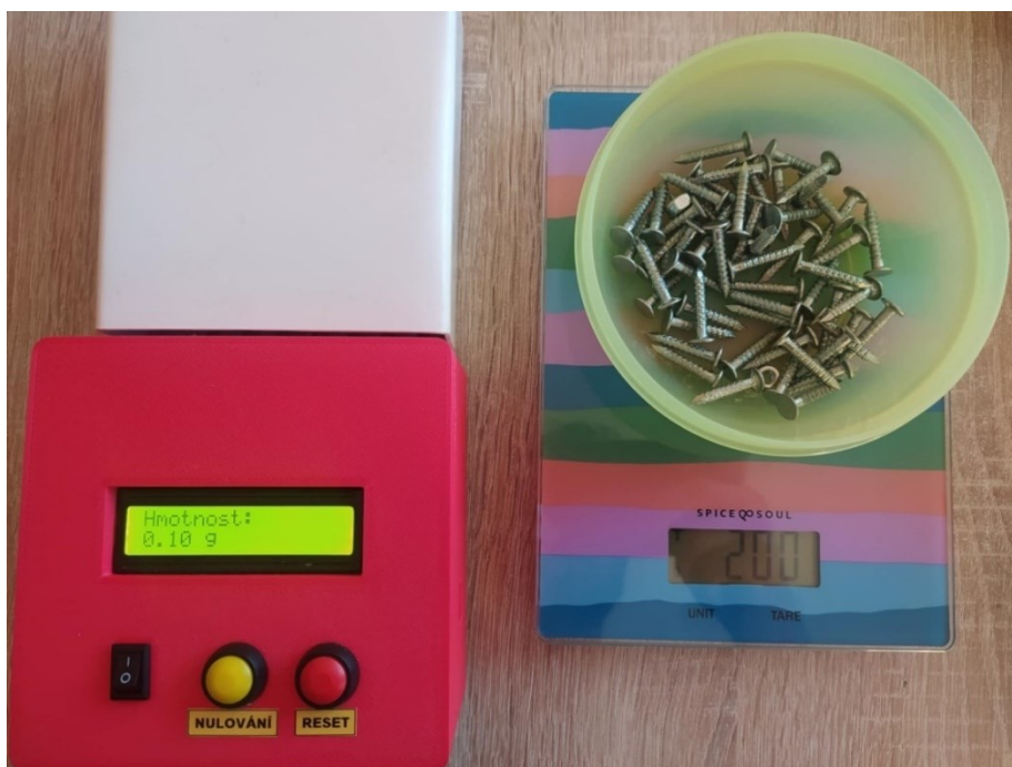
Obr. 142 – Testování jednotky pro měření hmotnosti – závaží na kuchyňské váze
