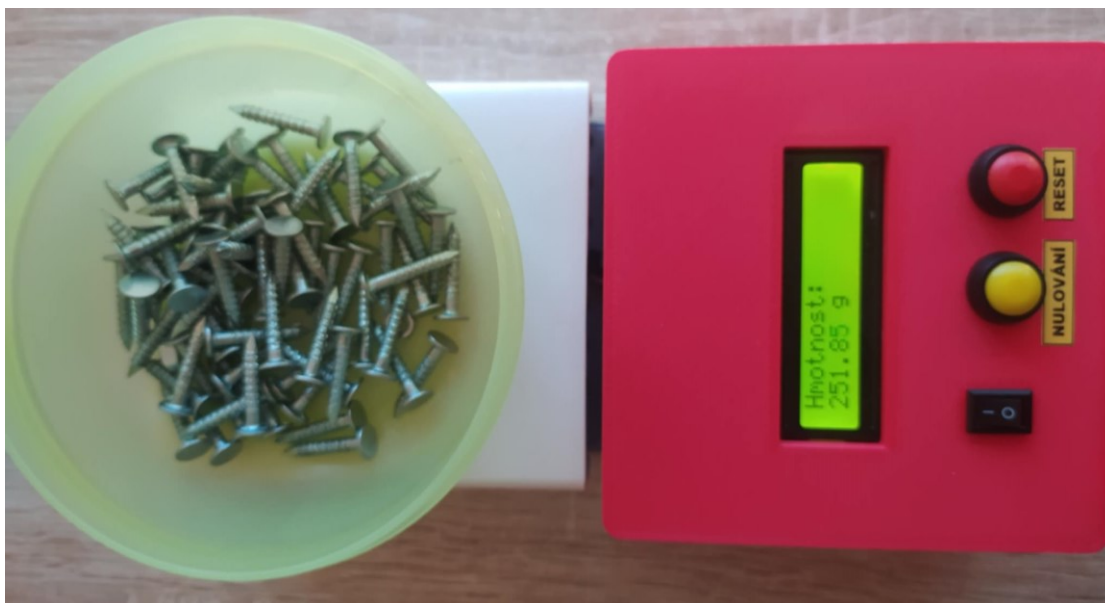
Obr. 105 – Jednotka pro měření hmotnosti – Vážení
