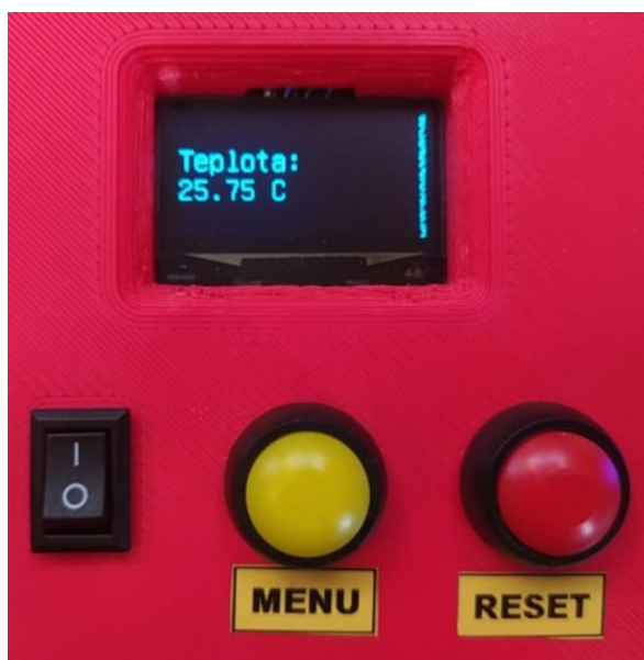
Obr. 75 – Zobrazení teploty na displeji jednotky pro příjem naměřených dat
