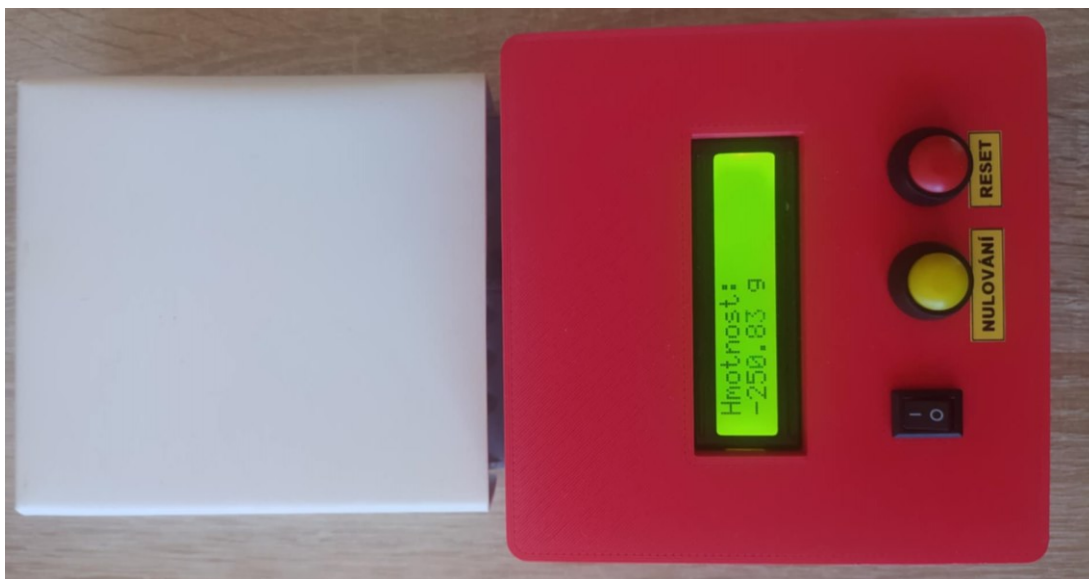
Obr. 107 – Jednotka pro měření hmotnosti – odebrání závaží
