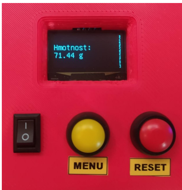
Obr. 76 – Zobrazení hmotnosti na displeji jednotky pro příjem naměřených dat
