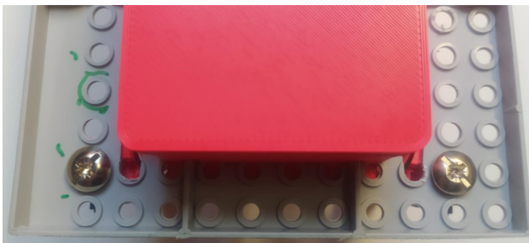
Obr. 91 – Šrouby, kterými jsou optické brány připevněny
