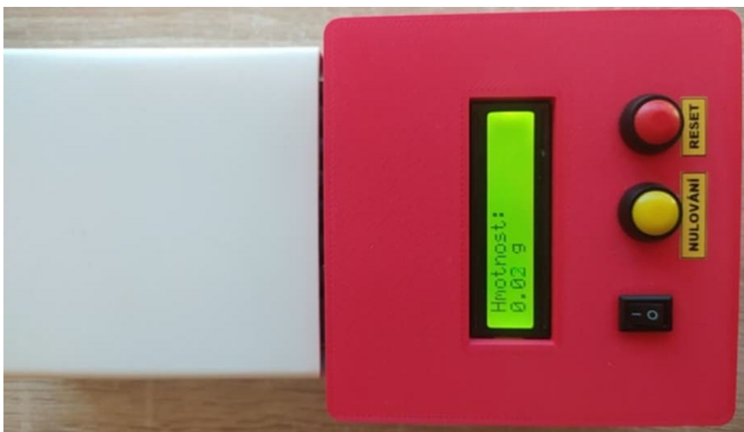
Obr. 108 – Jednotka pro měření hmotnosti – opětovné vynulování
