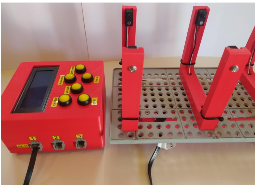
Obr. 89 – Optická brána připojená k jednotce pro měření rychlosti a zrychlení
