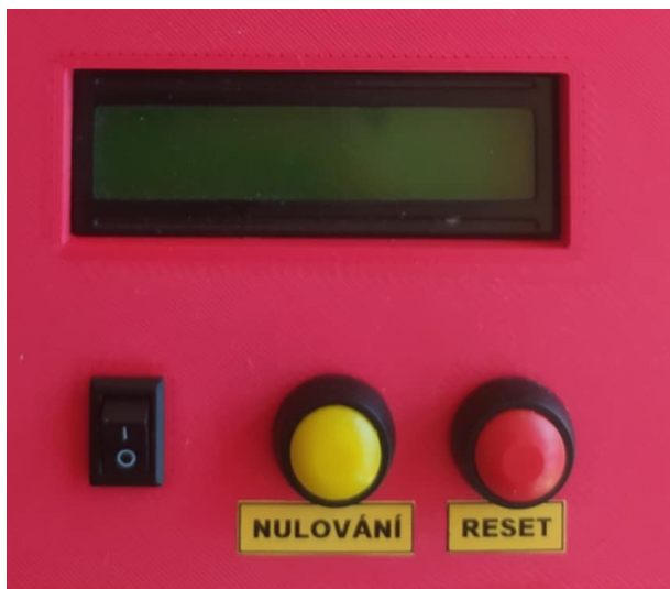
Obr. 103 – Ovládání jednotky pro měření hmotnosti
