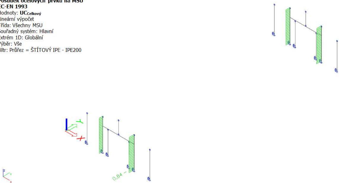
Obrázek 46 - Posouzení upraveného průřezu
