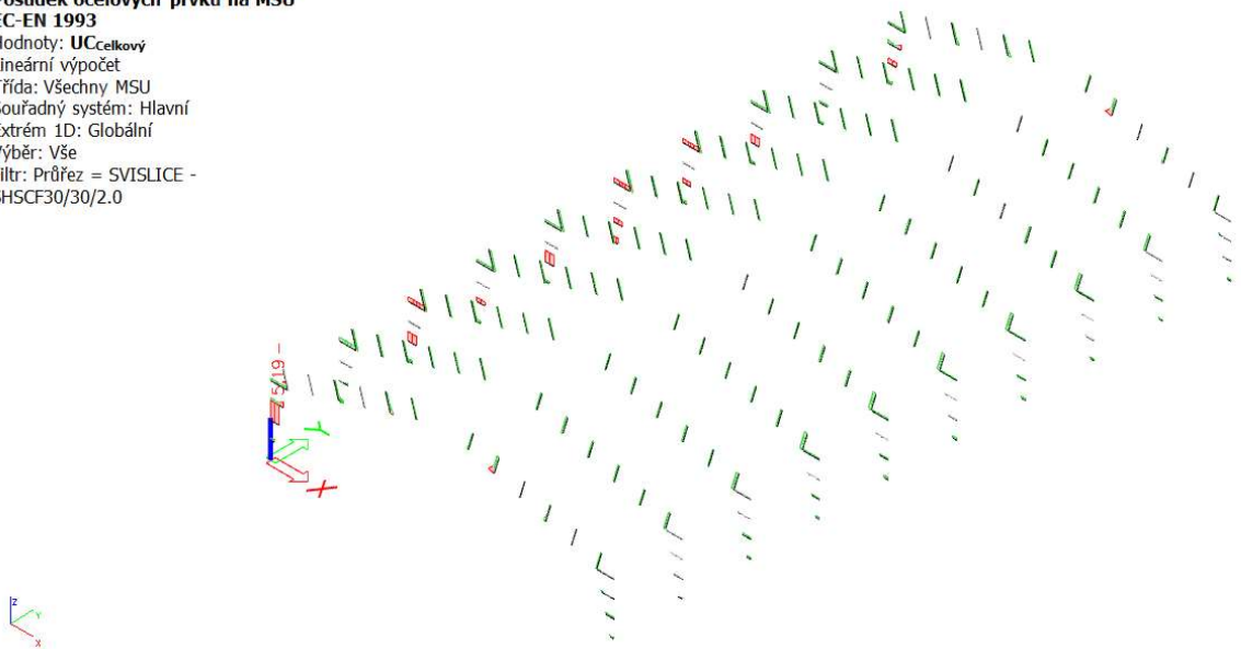
Obrázek 31 - Posouzení původního průřezu
