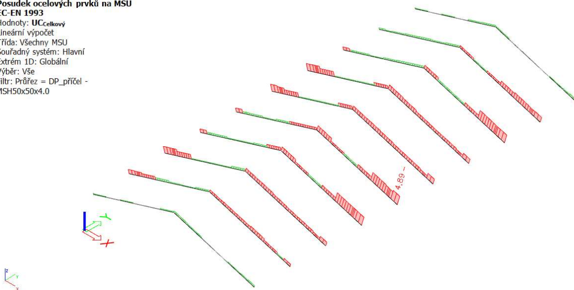
Obrázek 25 - Posouzení původního průřezu
