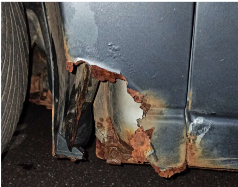
Obrázek 6: Příklad koroze spodní části předního blatníku [zdroj: vlastní]
