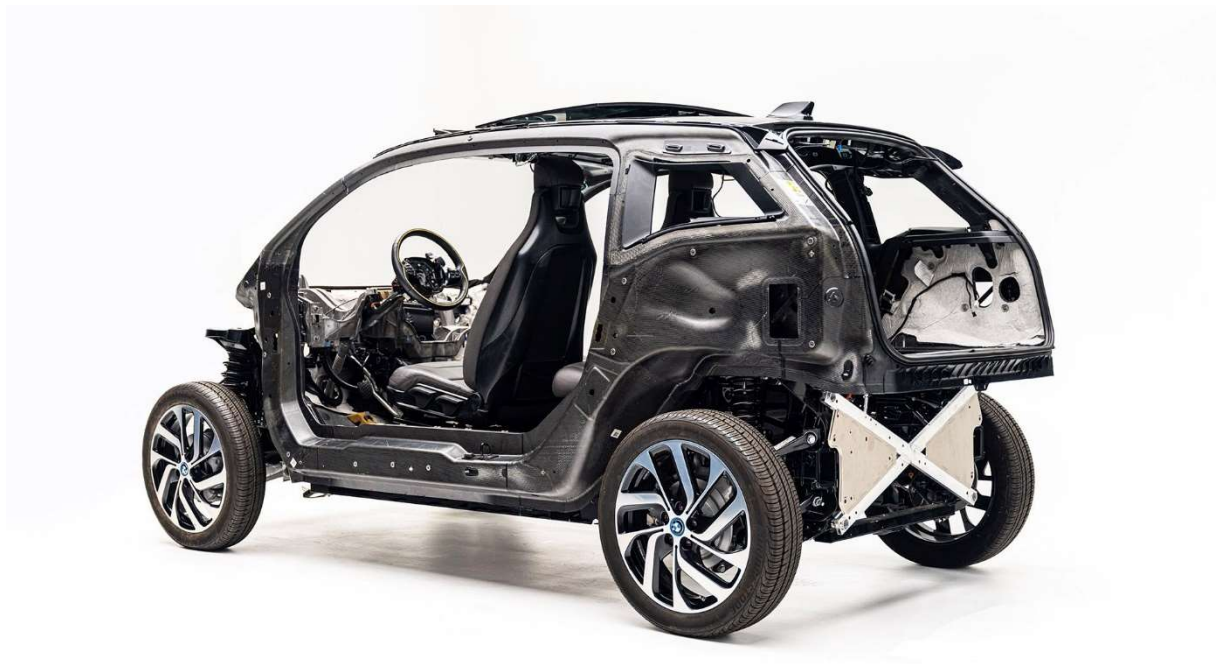
Obrázek 2: Karoserie vozu BMW i3 typu monokok z CFRP[13]
