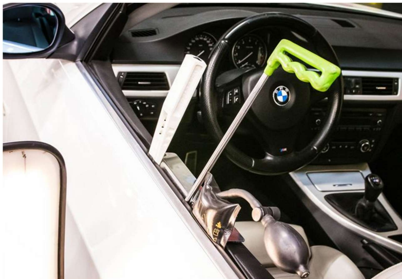
Obrázek 18: Oprava důlku ve dveřích pomocí PDR[30]
