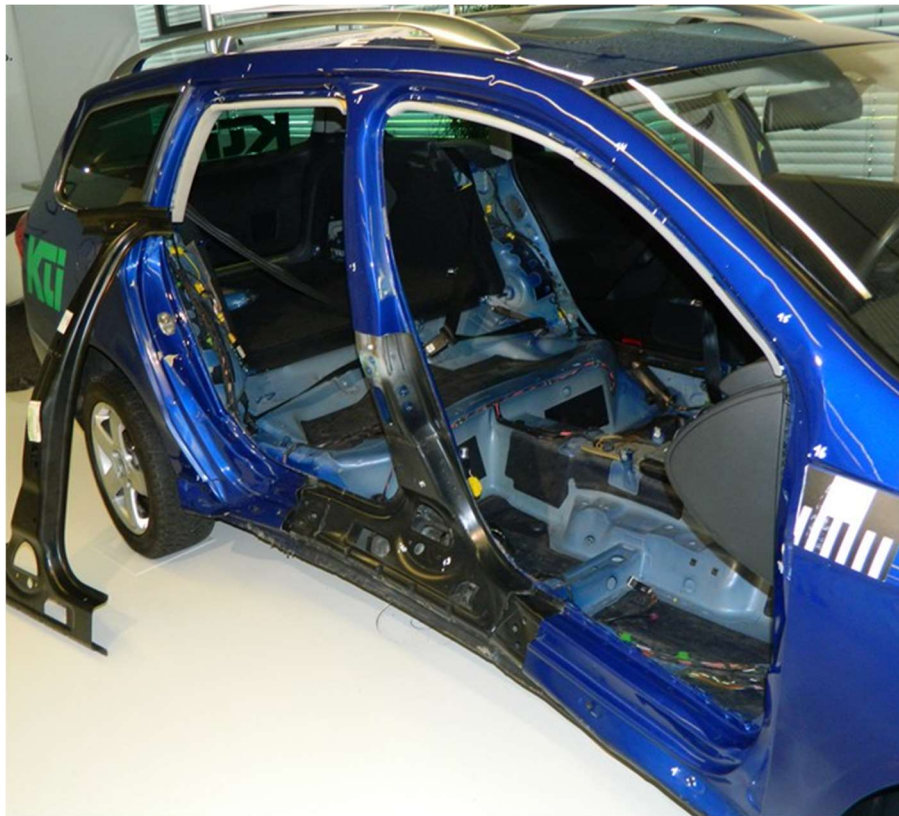
Obrázek 7: Příklad strukturního poškození[23]
