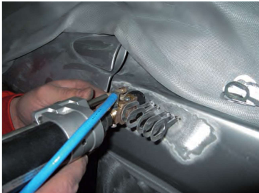
Obrázek 11: Použití jednostranné pistole ke spotteru s nástavcem pro vyrovnávání plechu [22]
