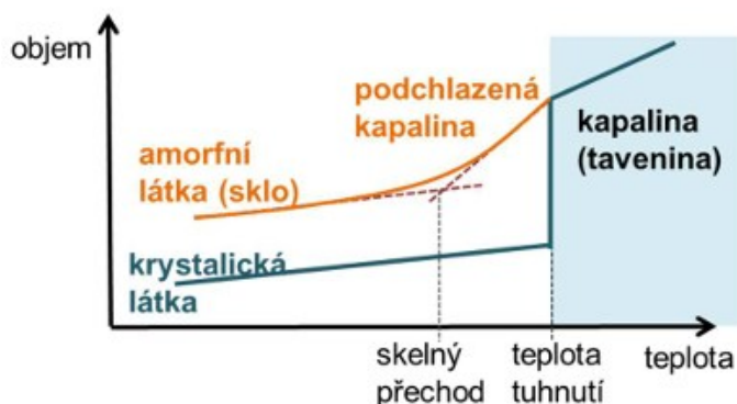
Obr. 1 Závislost objemu na teplotě při ochlazování kapaliny [3]
