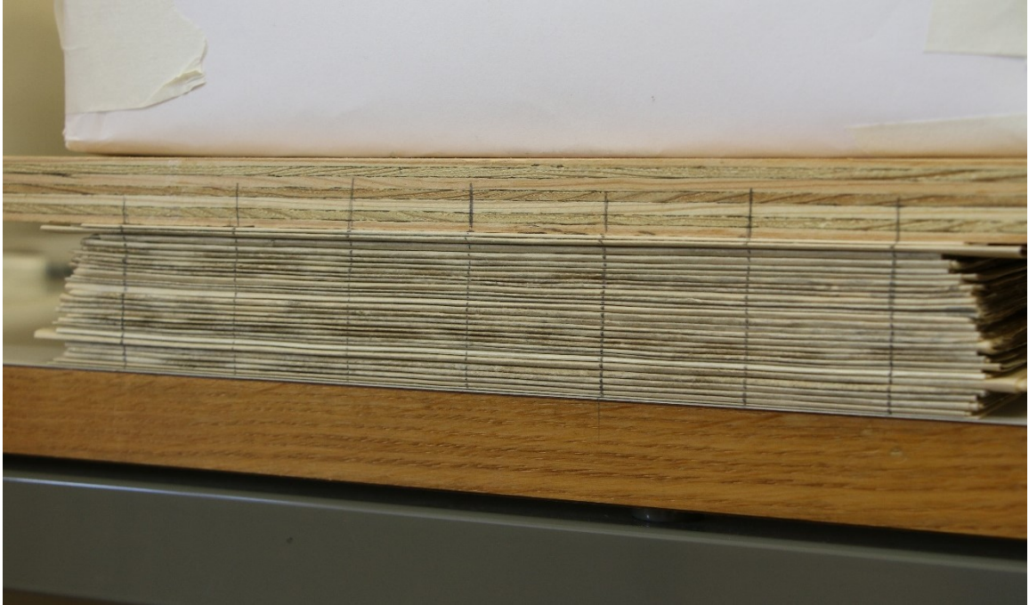
obr. 102 Zkompletovaný a vyzdušněný blok připravený na šití
