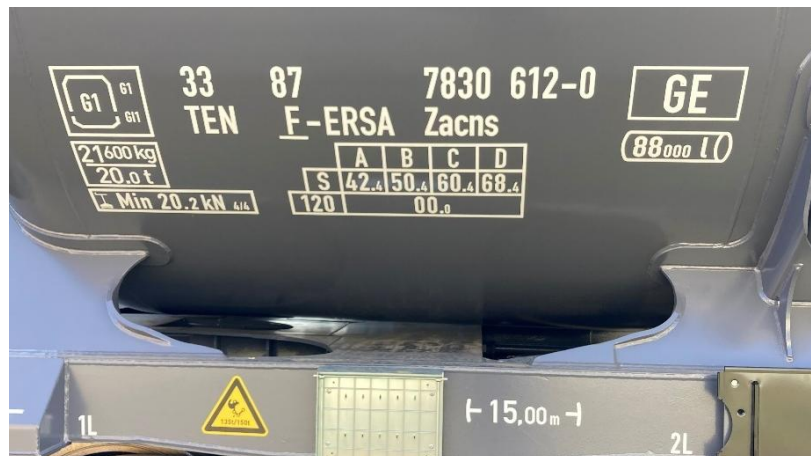
Obr. 3 Technického značení ne cisternovém voze Zacns dle předpisů RID a TSI
