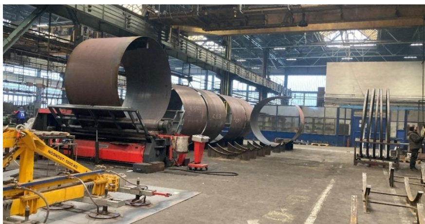
Obr. 8 Výrobní linka společnosti Nymwag CS na přípravu lubů
