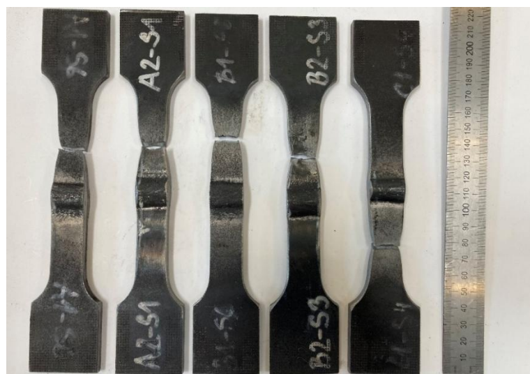
Obr. 19 Zkušební vzorky po provedení tahových zkoušek
