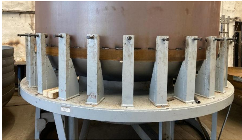
Obr. 9 Spojení dna s lubem v přípravku, pracoviště společnosti Nymwag CS
