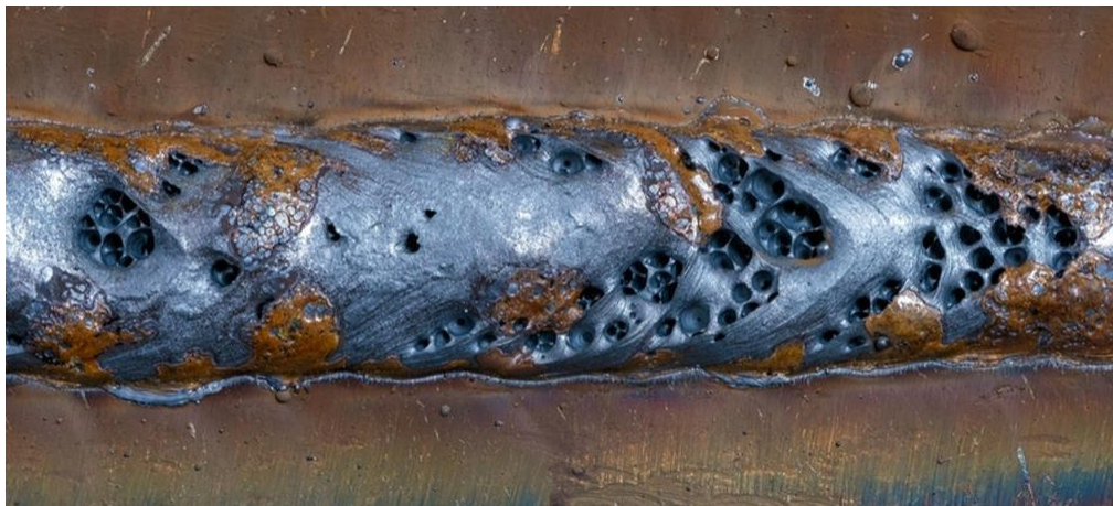
Obr. 14 Svar s výraznou pórovitostí [39]
