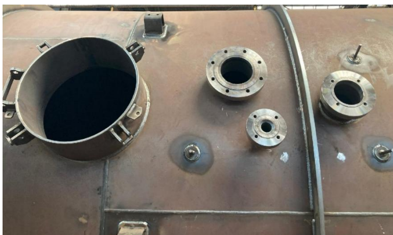
Obr. 10 Montáž přírub, průlezu a dalšího příslušenství
