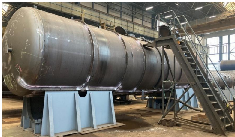
Obr. 11 Kompletní kotel po výstupní kontrole a tlakové zkoušce
