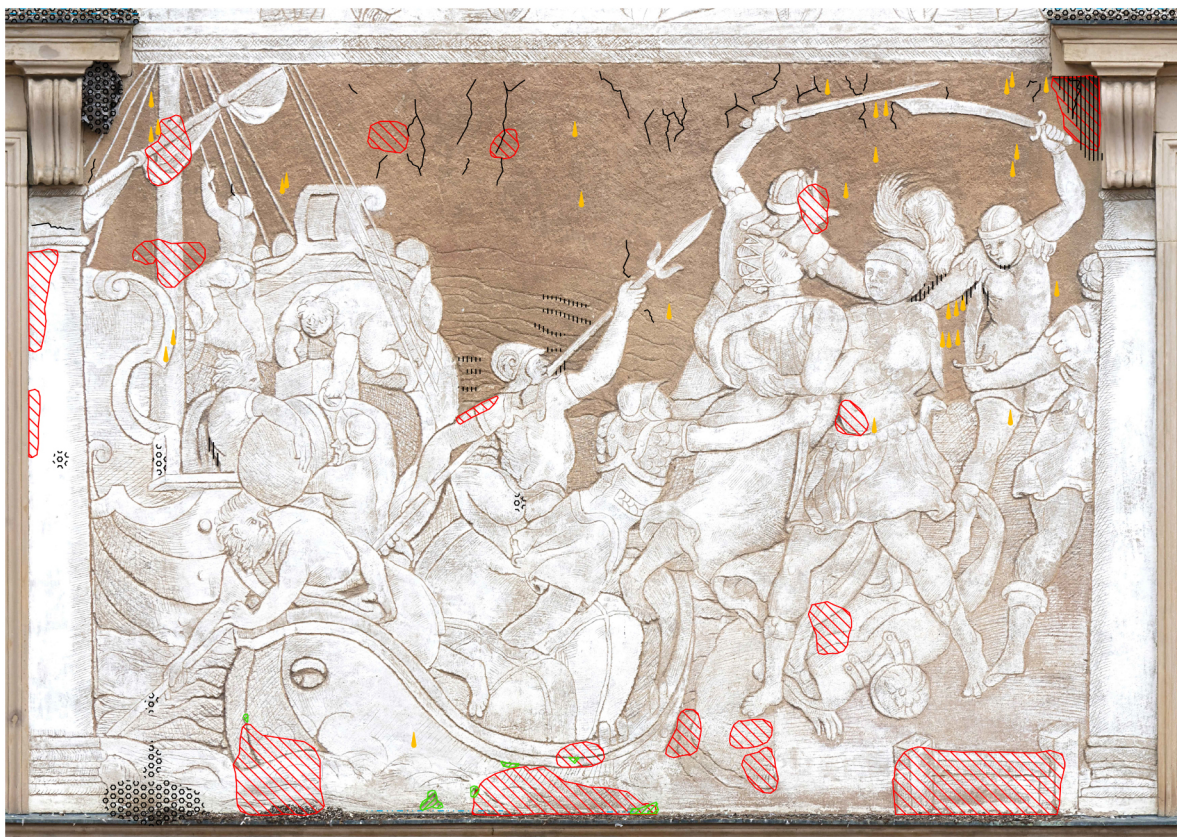
Obr. 58: Grafický zákres poškození na výjevu „Únos Heleny Trojské“ – Zákres zobrazuje poškození nacházející se na restaurovaném díle, včetně ztráty omítkových vrstev, dutin a trhlin. Dále také znečištění povrchu výjevu v podobě cákanců, biologického napadení (ptačí trus, vosí hnízdo), zžemalého povrchu a korozních produktů mědi.
