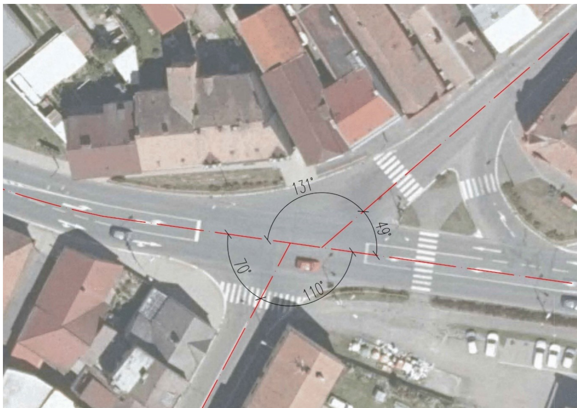
Obr. 4: Letecký pohled stávající průsečné křižovatky a schéma úhlů křížení paprsků.
