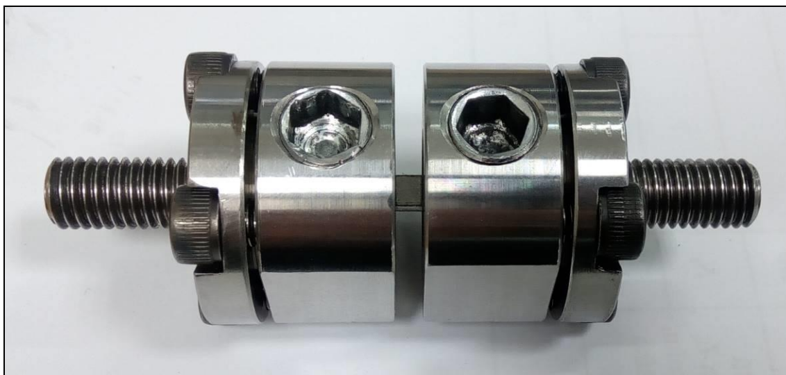
Obrázek 22: Upínací zařízení se vzorkem
