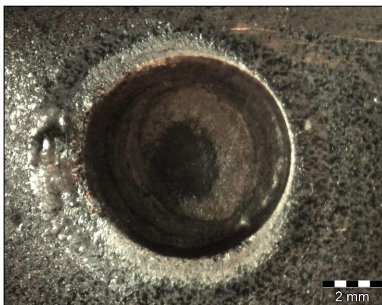
Obrázek 6: Snímek svarové čochky
