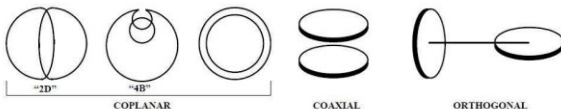
Obrázek 3 - Uspořádání cívek u balančních detektorů(1)
