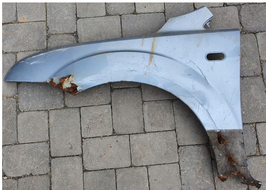
Obrázek 10 Odpad z vozidla s ukončenou životností
