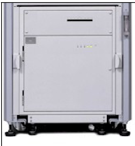
Obr. 19 Vyhříváný systém OVN pro analyzátory HC, NO x , CH 4
