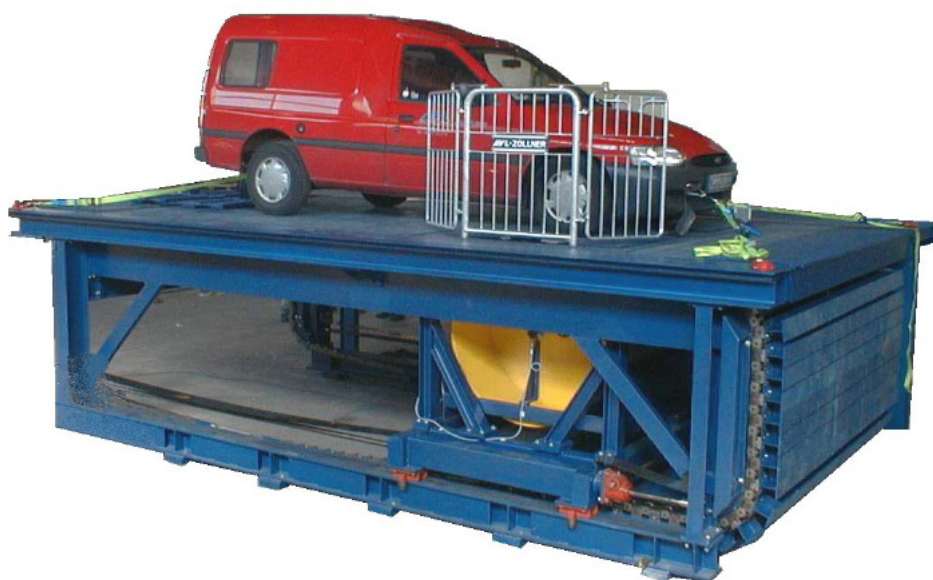
Obr. 11 Šasi a mechanická část zkušební stanice AVL 48“ COMPACT 2WD
