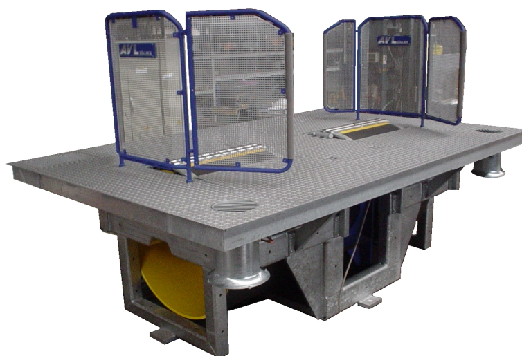
Obr. 10 Válcová zkušební stanice AVL 48" COMPACT 2WD provedení pro použití v klimatické komoře
