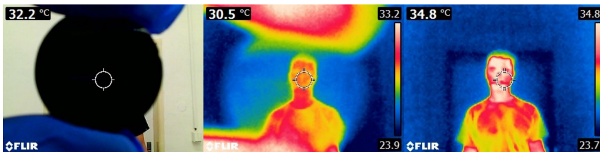
Obrázek 1.4: Snímky selenidového skla z termokamery FLIR E5 ve zvoleném režimu – digitální kamera (vlevo); tepelný režim (uprostřed); snímek bez selenidového skla v tepelném režimu (vpravo).
