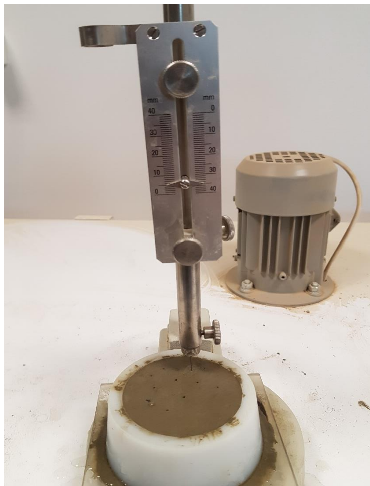
Obrázek 27: Počátek tuhnutí (vzorek Odra)
