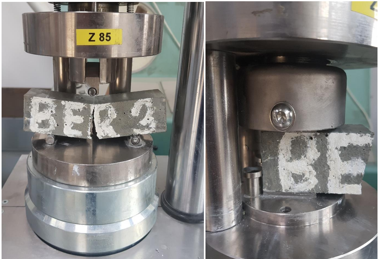
Obrázek 23: Zkoušení pevnosti v tahu za ohybu a pevnosti v tlaku (vzorek Berlín)
