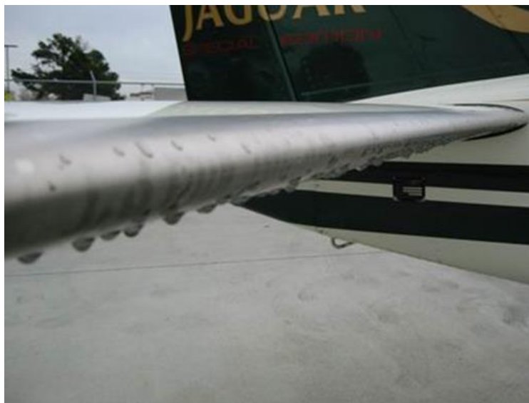
Obrázek 18 - Vylučování kapaliny TKS z křídla
