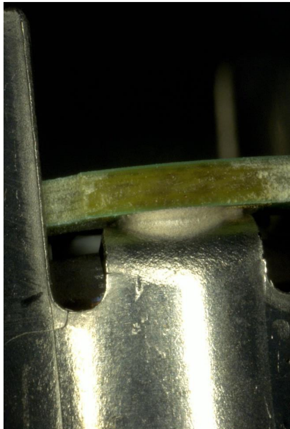
Obrázek 29 ECA přetekla přes okraj spoje
