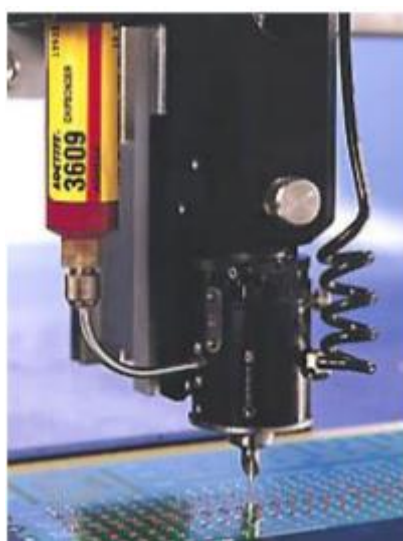
Obrázek 24 Nanášení ECA automatickou disperzní hlavou
