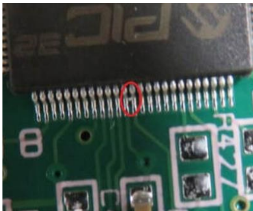
Obrázek 30 Na obrázku jsou zakroužkované FTP spoje
