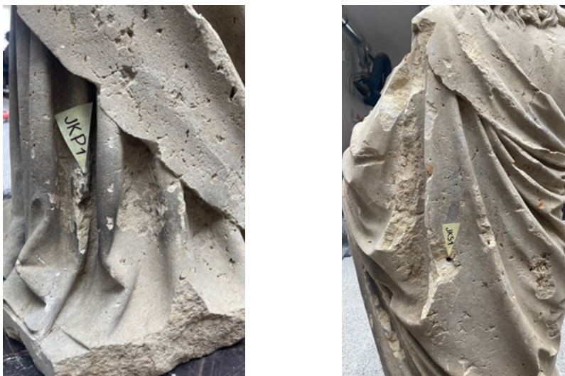
Obr. 2 a-b: Místa odběru vzorků JKPI a JKSI. Foto a grafická úprava: Matěj Lett.
