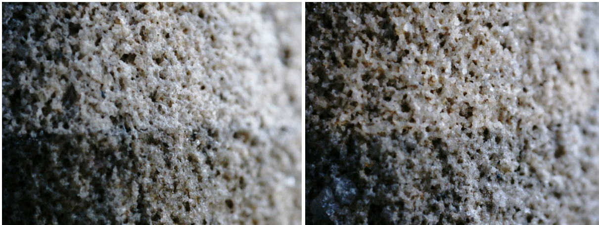
Obrázek 25 detail mikropískování 1 bar laser 180
