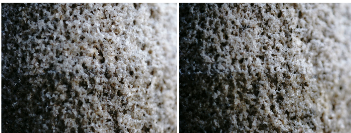
Obrázek 23 detail mikropískování 2 bary
