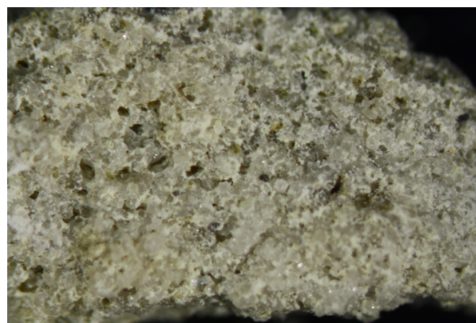
Obr. 3 a-c: a) Místo odběru povrchové krusty JKP1. b-c) Makrosnímky lícové a rubové strany vzorku. Snímky v odraženém světle stereomikroskopu SMZ 800 (Nikon), fotografováno při zvětšení na mikroskopu 2x.
