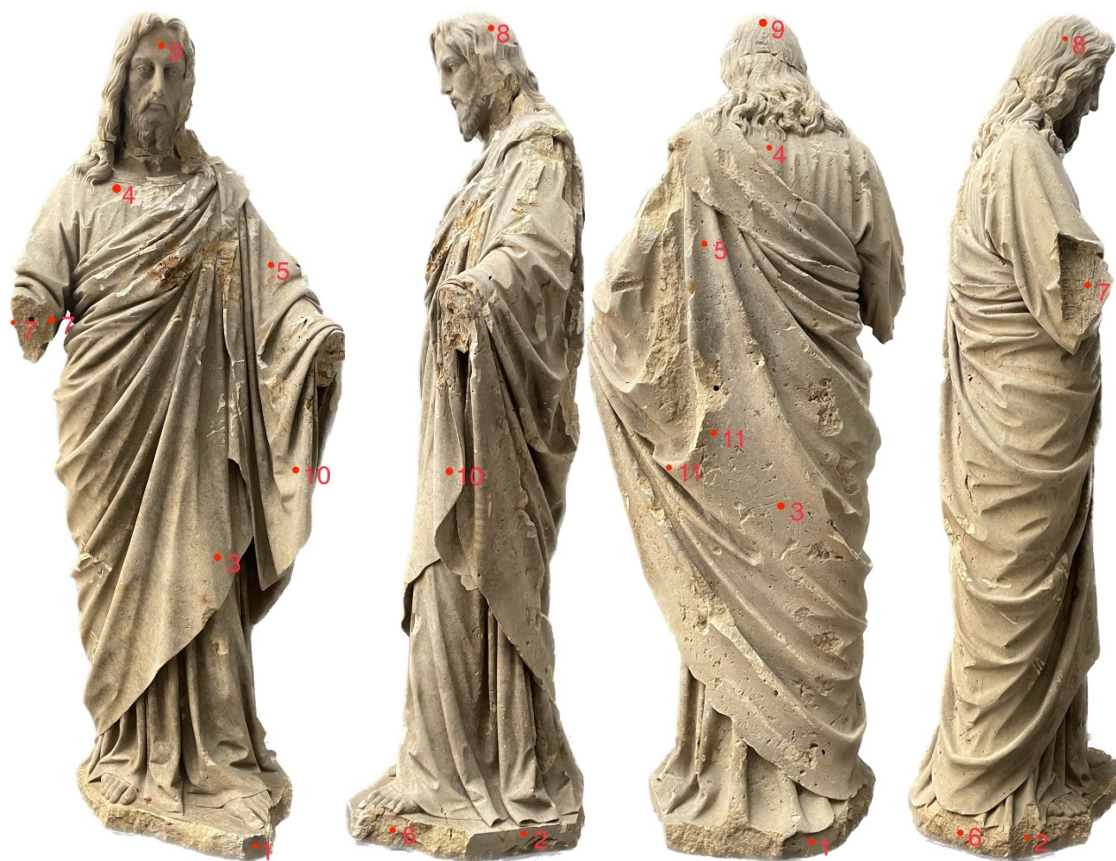
Obrázek 18 Místa měření ultrazvuku
