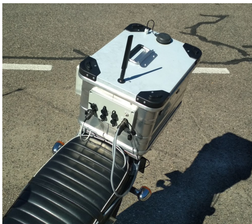
Obrázek 27: Uchycení měřícího kufu na motocyklu
