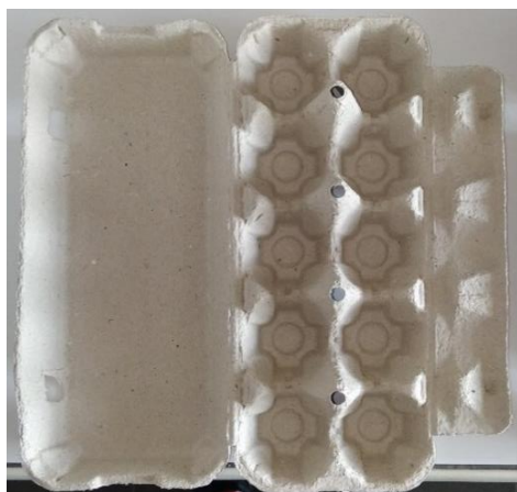
Obrázek 9: Vzorek od výrobce používající separátory na bázi solí PA a SA – tmavý.
