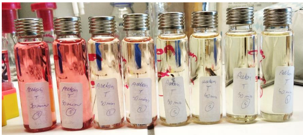
Příloha 1: Extrakty testovacích vzorků v acetonu za použití H_2SO_4 (foceno ihned po přípravě).
