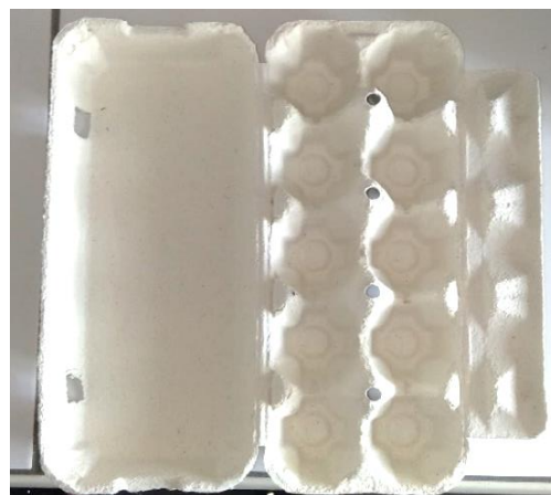
Obrázek 10: Vzorek od výrobce používající separátory na bázi solí PA a SA – světlý.
