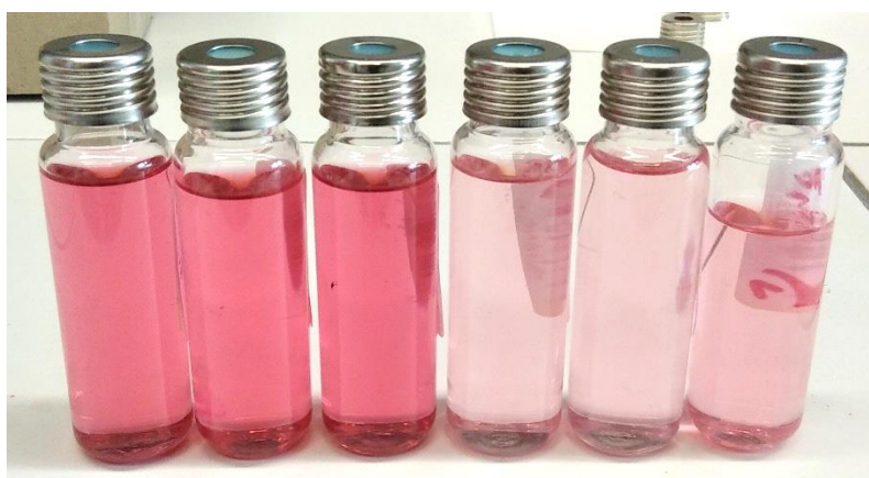
Příloha 3: Extrakty ze vzorků (aceton + H_3PO_4 ), zleva: 3 extrakty z tmavších obalů, 3 ze světlejších.
