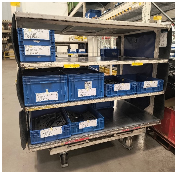
Obrázek 11 Vozík pro rozvoz materiálu v KLT boxech (Autor, 2025)
