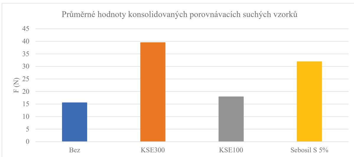
Graf TH 10 Průměrné výsledky odporu při vrtání, konsolidované porovnávacích vzorky
