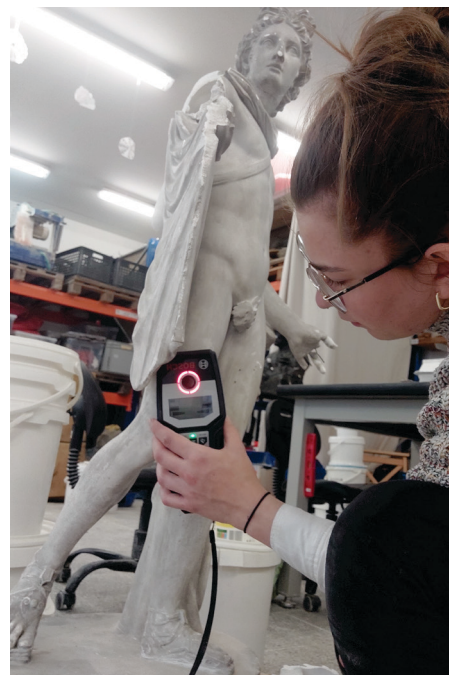
Obr. PR. 2 Detekce kovových armatur
