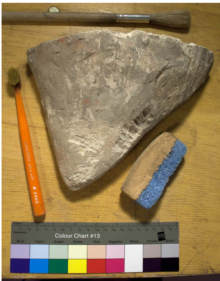
Obr. 157) Jean Baptiste Dieussard, Při postupném odkrývání prasklin docházelo současně také k suchému čištění, které mohlo být v zadních partiích bez polychromií důkladnější (nikde ze zadní strany otočené ke skalisku nebyly). Čištění probíhalo prvně štětcem s delším chlupem, poté měkkými nekovovými kartáčky a nakonec jsme dočistili povrch houbami Wishab. Hornická grotta, sala terrena, AZ Kroměříž. 1686–1695.
