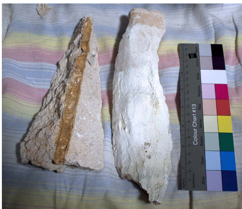
Obr. 172) Průběh snímání nepůvodních sádrových tmelů z povrchu štuku. Hornická grotta, sala terrena, AZ Kroměříž. 1686–1695.
