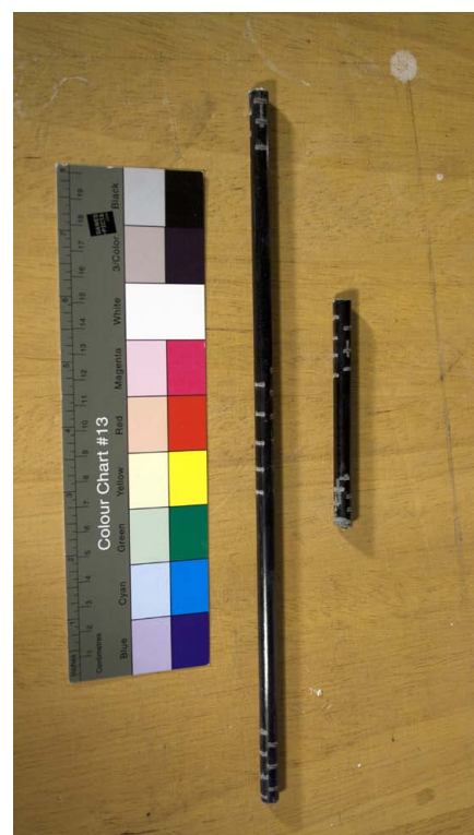
Obr. 186) Ukázka nových nekovových armatur se zářezy pro lepší adhezi ke štukce. Hornická grotta, sala terrena, AZ Kroměříž. 1686–1695.
