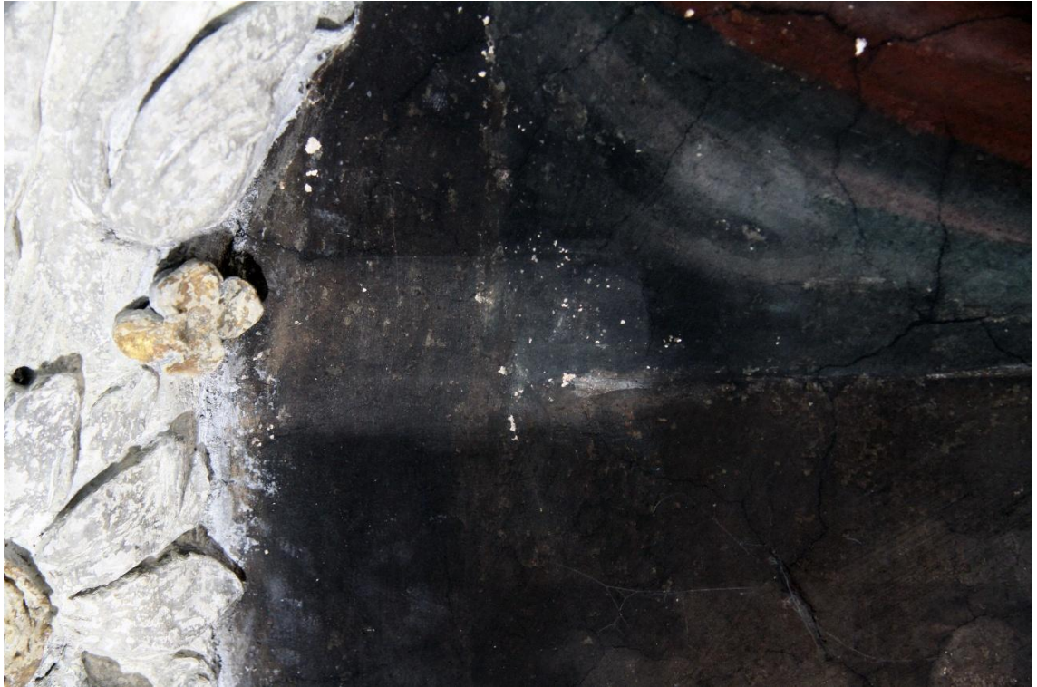
Obr. č. 10 Zkouška čištění prachového depositu (sazí) pomocí latexové houby Akapad
