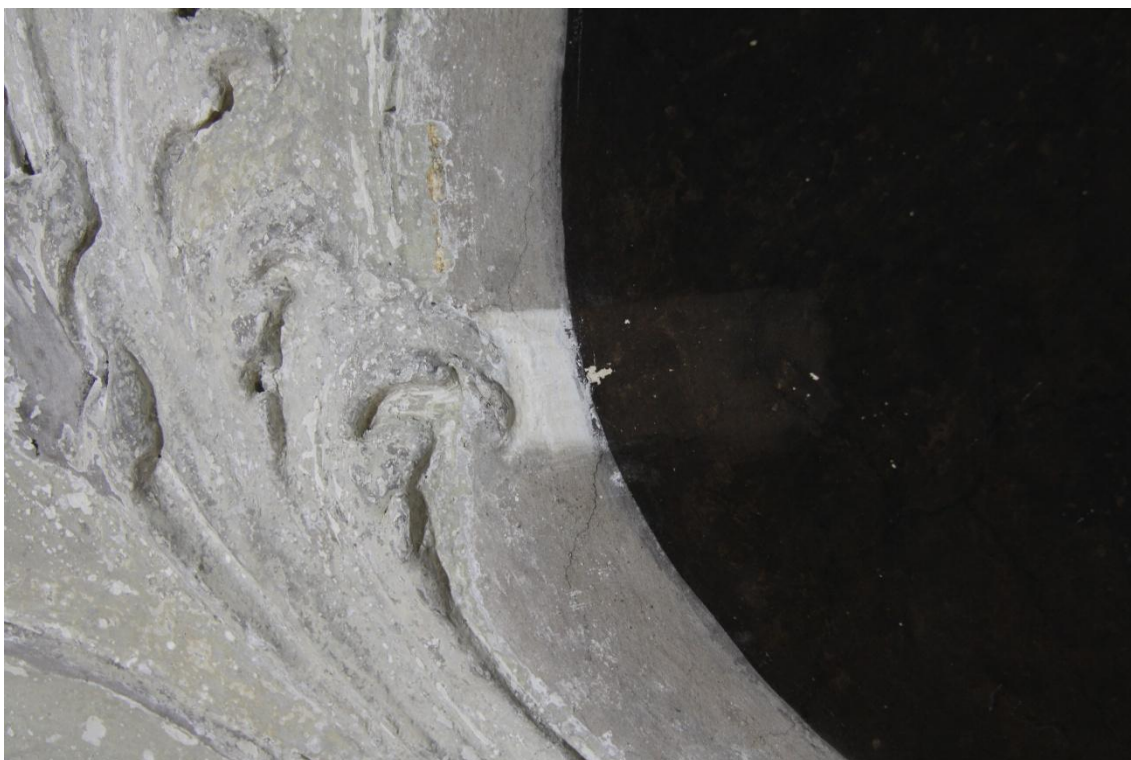
Obr. č. 34 Zkouška čištění prachového depositu (sazí) pomocí latexové houby Akapad .
