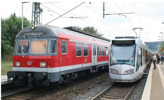
Obr. 24: Vlak a tramvaj na jednom nádraží v Kasselu, ilustrace rozdílnosti nástupišť pro vlaky a tramvaje (Zdroj: IDSK)
