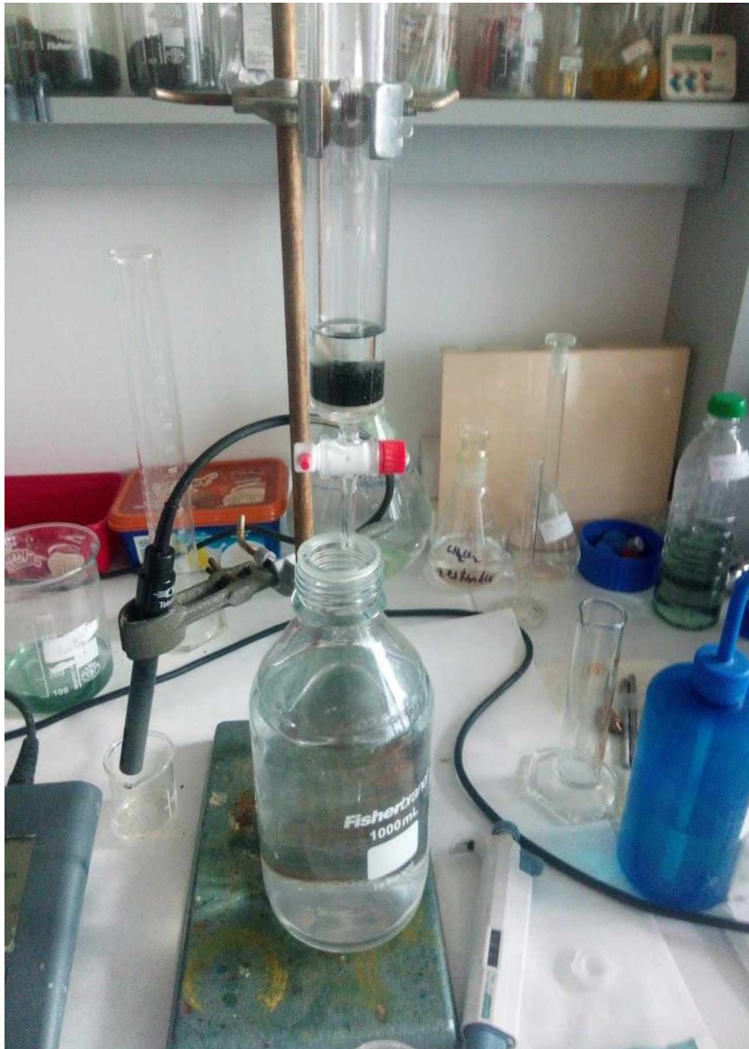
Obr. 8: Kolonové uspořádání experimentů pro stanovení celkové kapacity silně kyselého katexu Lewatit Mono Plus S108
