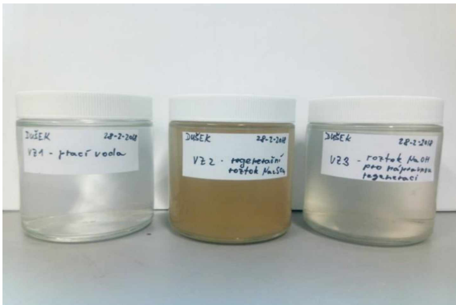
Obr. 6: Zleva doprava: vzorky čištěné odpadní vody VZ1, síranu sodného používaného pro regeneraci iontoměniče VZ2 a hydroxidu sodného se zbytky síranu sodného a zinečnatého používaného pro nápravnou regeneraci kyselého katexu VZ3.
