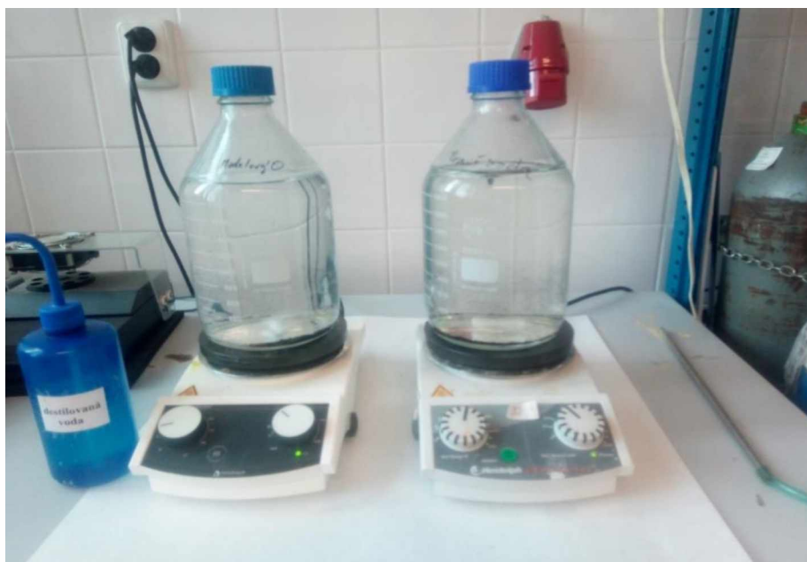
Obr. 7: Vsádkové uspořádání experimentů pro stanovení celkové kapacity silně kyselého katexu Lewatit Mono Plus S108
