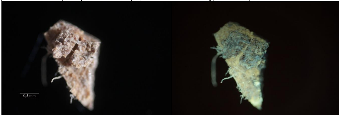
Obr. 52, 53 Optická mikroskopie, vzorek ze spodní strany, bílé světlo, UV fluorescence.
