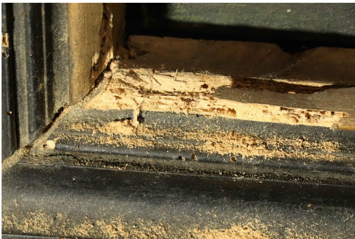
Obr. 197: Stav před restaurováním, detail poškození, ozdobný rám napadený aktivním dřevokazným hmyzem (červotoč).
