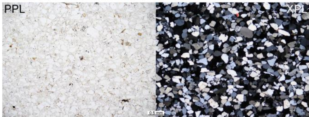
Obr. 9: Vzorek Praha – mikrostruktura s nevýraznou přednostní orientací
