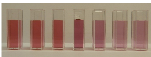
Obrázek 65: Koloidní roztoky nanočástic AuNPs (ZA), barevná změna v závislosti na množství přidaného mPEG-SH, zleva 0, 5, 10, 50, 100, 200, 500 nmol mPEG-SH
