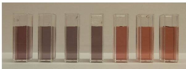
Obrázek 64: Koloidní roztoky nanočástic AuNPs (BS), barevná změna v závislosti na množství přidaného mPEG-SH, zleva 0, 5, 10, 50, 100, 200, 500 nmol mPEG-SH
