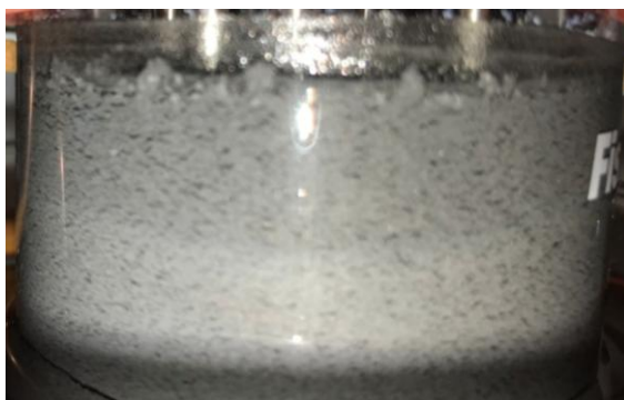
Obr. 30 míchaná suspenze při ukončení dávkování roztoku surfaktantu
