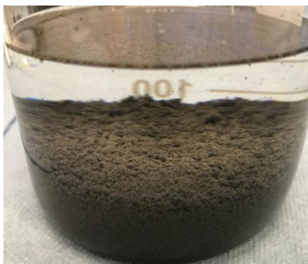
Obr. 31 usazené částice na dně nádoby po ukončení míchání
